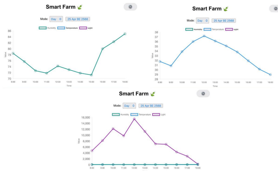
รูปที่ 4.43 กราฟแสดงค่าความชื้นสัมพัทธ์ (เปอร์เซ็นต์) ค่าอุณหภูมิ (องศาเซลเซียส) และค่าความเข้มแสง (ลักซ์) วันที่ 25 เมษายน 2568 (วันที่ 7 ในการเก็บค่า)
