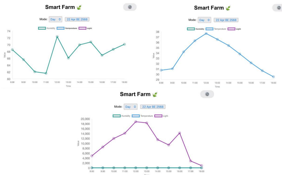
รูปที่ 4.40 กราฟแสดงค่าความชื้นสัมพัทธ์ (เปอร์เซ็นต์) ค่าอุณหภูมิ (องศาเซลเซียส) และค่าความเข้มแสง (ลักซ์) วันที่ 22 เมษายน 2568 (วันที่ 4 ในการเก็บค่า)
