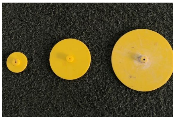
รูปที่ 3.21 จานหมุนเหวี่ยงรดน้ำ 3 ขนาด (3 เซนติเมตร 6 เซนติเมตร และ 9 เซนติเมตร) ตามลำดับ
