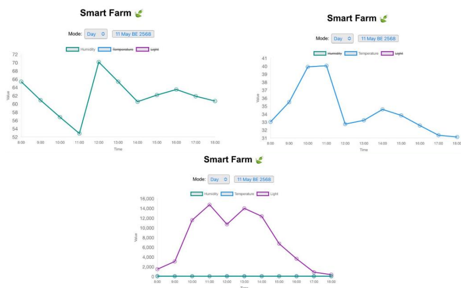
รูปที่ 4.58 กราฟแสดงค่าความชื้นสัมพัทธ์ (เปอร์เซ็นต์) ค่าอุณหภูมิ (องศาเซลเซียส) และค่าความเข้มแสง (ลักซ์) วันที่ 11 พฤษภาคม 2568 (วันที่ 8 ในการเก็บค่า)
