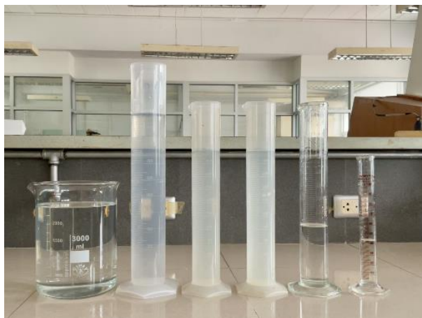
รูปที่ 3.20 การทดสอบอัตราการไหลของปั้มน้ำเพื่อวัดปริมาณน้ำที่ออกจากหัวจ่าย (2 หัวจ่าย)
