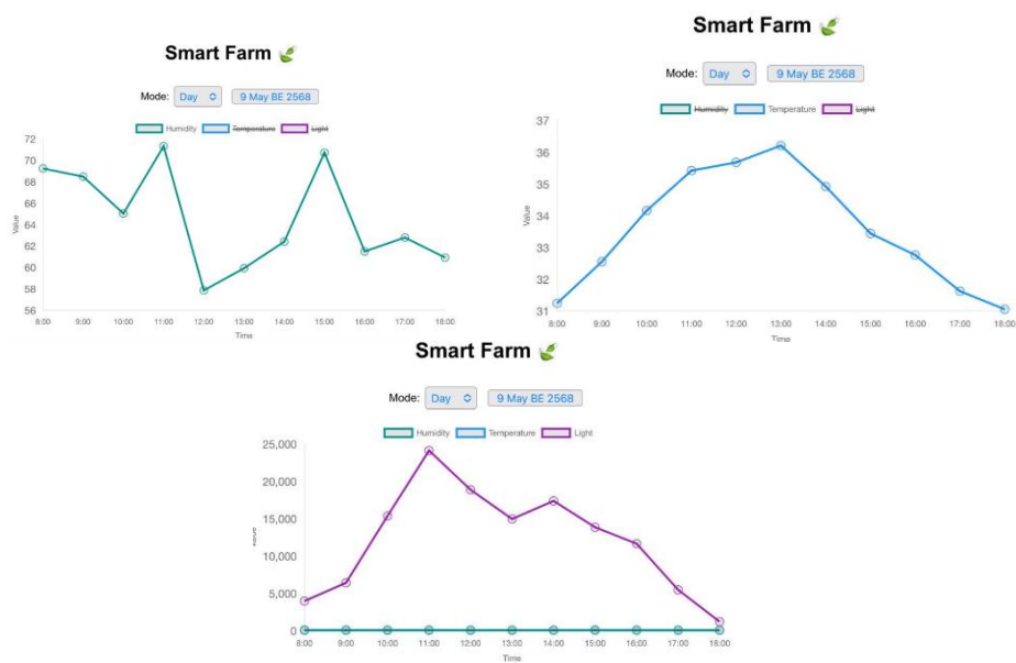
รูปที่ 4.56 กราฟแสดงค่าความชื้นสัมพัทธ์ (เปอร์เซ็นต์) ค่าอุณหภูมิ (องศาเซลเซียส) และค่าความเข้มแสง (ลักซ์) วันที่ 9 พฤษภาคม 2568 (วันที่ 6 ในการเก็บค่า)
