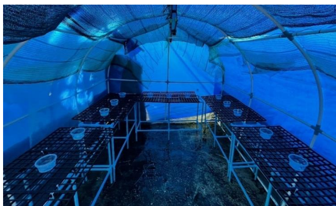
รูปที่ 3.23 การทดสอบการกระจายน้ำเพื่อหาปริมาณน้ำแต่ละจุด จำนวน 5 จุด
