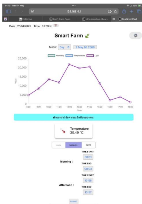
รูปที่ 3.31 หน้าเว็บเซิร์ฟเวอร์แสดงกราฟค่าความเข้มแสง(ลักซ์)
