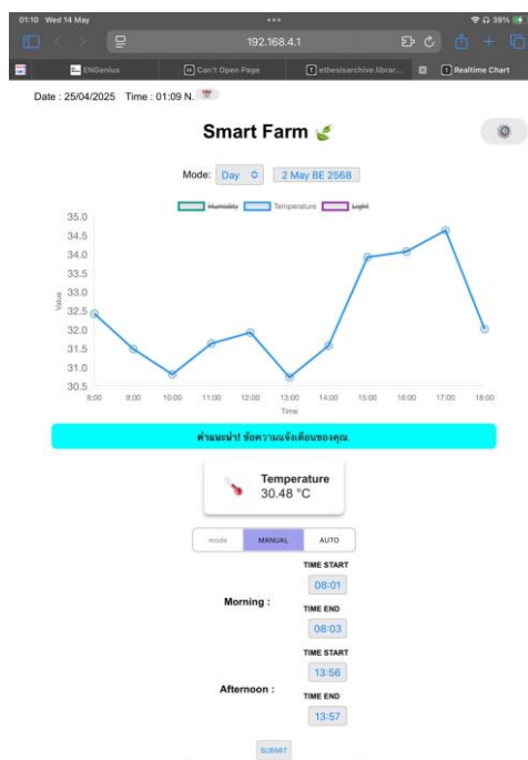
รูปที่ 3.30 หน้าเว็บเซิร์ฟเวอร์แสดงกราฟค่าอุณหภูมิ (องศาเซลเซียส)
