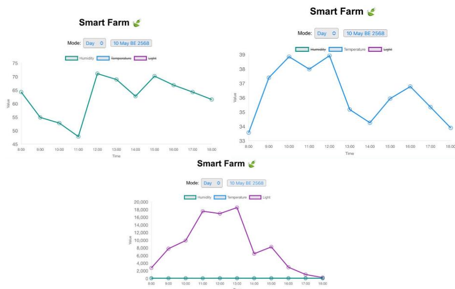
รูปที่ 4.57 กราฟแสดงค่าความชื้นสัมพัทธ์ (เปอร์เซ็นต์) ค่าอุณหภูมิ (องศาเซลเซียส) และค่าความเข้มแสง (ลักซ์) วันที่ 10 พฤษภาคม 2568 (วันที่ 7 ในการเก็บค่า)
