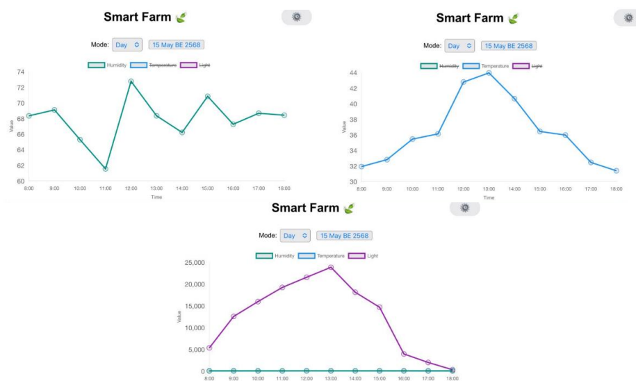
รูปที่ 4.62 กราฟแสดงค่าความชื้นสัมพัทธ์ (เปอร์เซ็นต์) ค่าอุณหภูมิ (องศาเซลเซียส) และค่าความเข้มแสง (ลักซ์) วันที่ 15 พฤษภาคม 2568 (วันที่ 12 ในการเก็บค่า)
