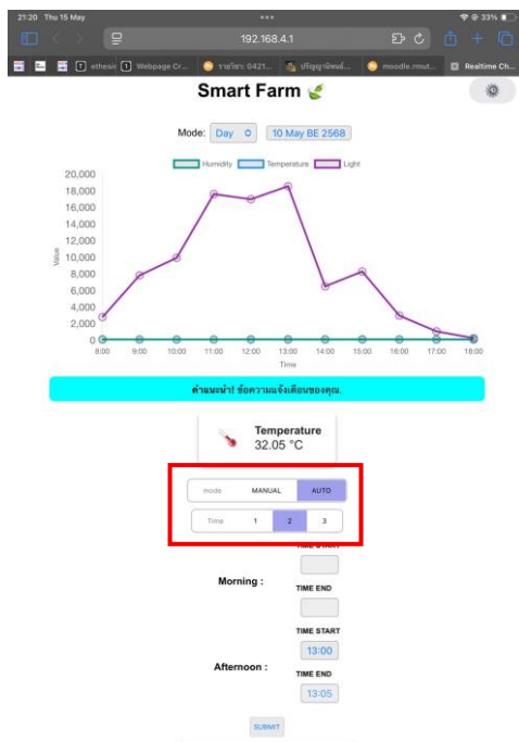
รูปที่ 3.35 การทดสอบสั่งการทำงานของระบบในโหมดอัตโนมัติ (Auto Mode 2) ผ่านเว็บเซิร์ฟเวอร์
