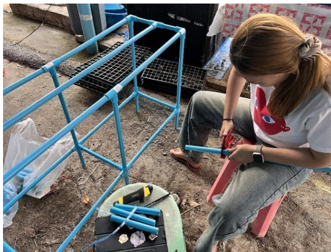
รูปที่ 3.10 ประกอบฐานวางถาดเพาะปลูกต้นกล้าภายในโรงเรือน
