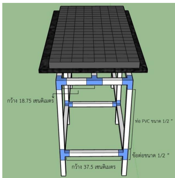
รูปที่ 3.4 แบบจำลองการออกแบบโครงสร้างฐานวางเพาะปลูกภายในโรงเรือนเพาะต้นกล้าด้วยเทคโนโลยีระบบควบคุมอุณหภูมิและแสงสว่างอัตโนมัติ (ด้านข้าง)
