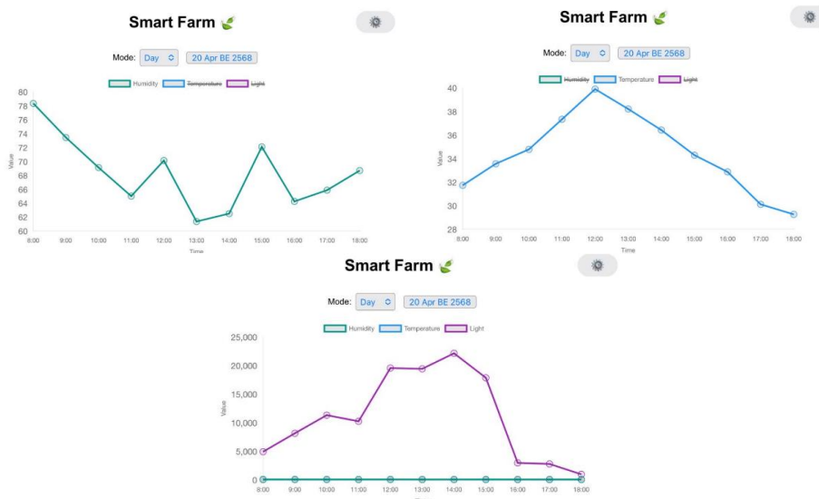
รูปที่ 4.38 กราฟแสดงค่าความชื้นสัมพัทธ์ (เปอร์เซ็นต์) ค่าอุณหภูมิ (องศาเซลเซียส) และค่าความเข้มแสง (ลักซ์) วันที่ 20 เมษายน 2568 (วันที่ 2 ในการเก็บค่า)
