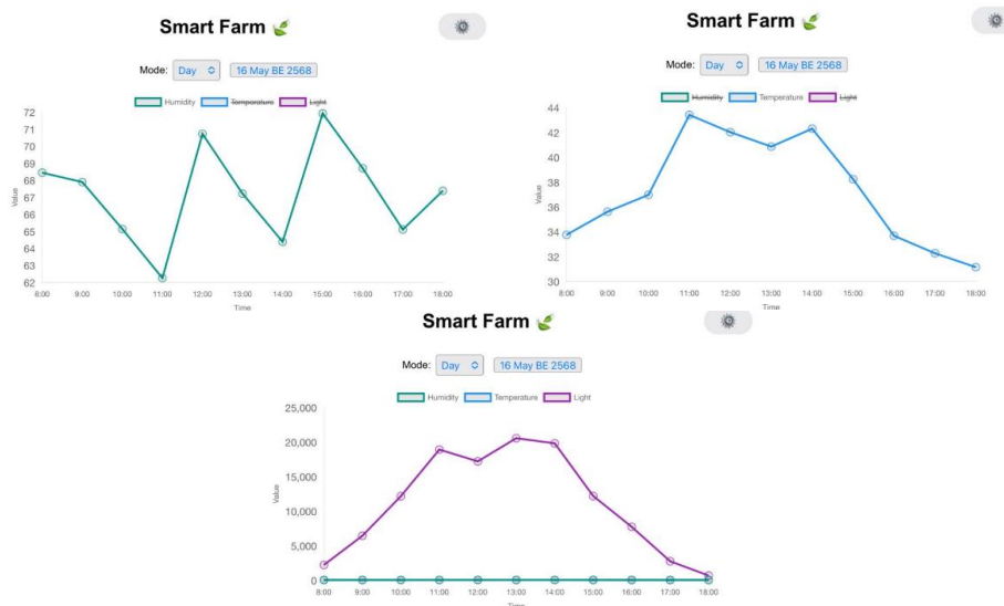
รูปที่ 4.63 กราฟแสดงค่าความชื้นสัมพัทธ์ (เปอร์เซ็นต์) ค่าอุณหภูมิ (องศาเซลเซียส) และค่าความเข้มแสง (ลักซ์) วันที่ 16 พฤษภาคม 2568 (วันที่ 13 ในการเก็บค่า)
