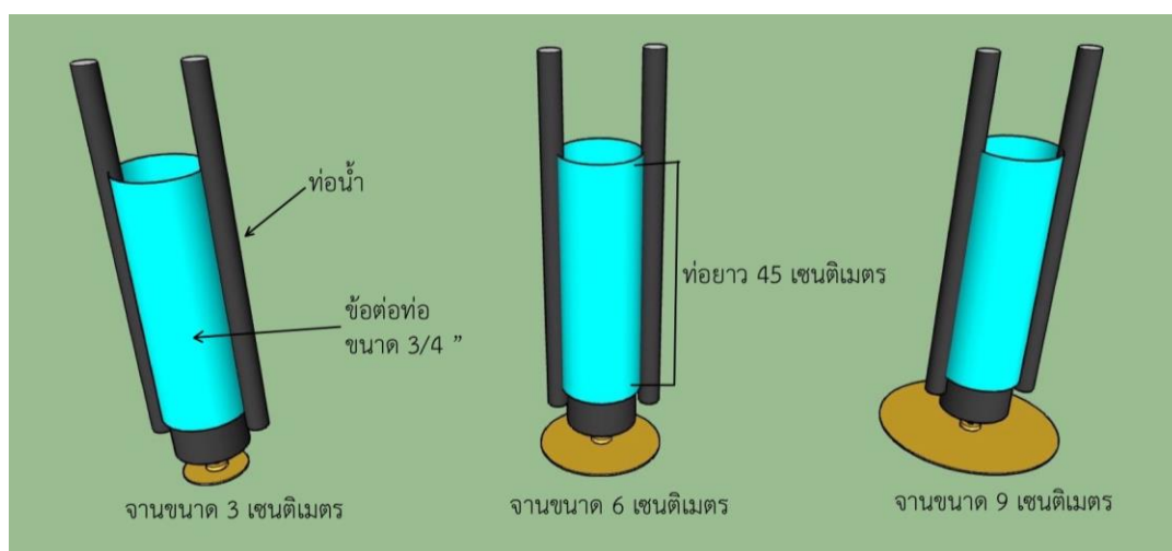
รูปที่ 3.8 แบบจำลองการออกแบบจานหมุนเหวี่ยงให้น้ำอัตโนมัติ
