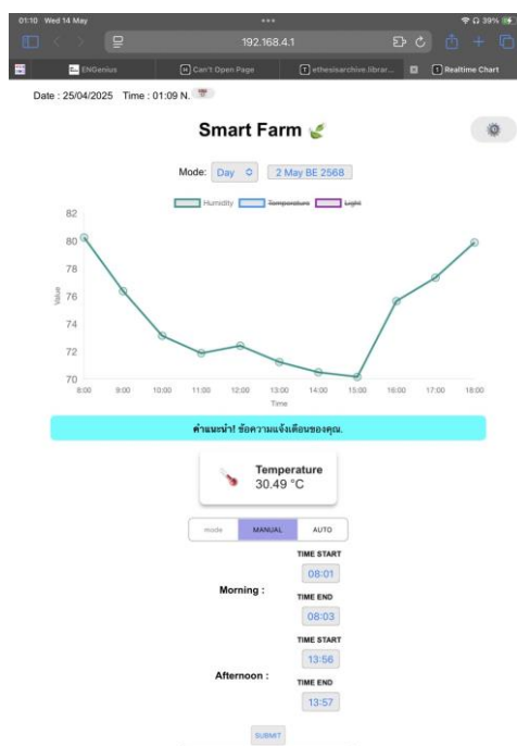
รูปที่ 3.29 หน้าเว็บเซิร์ฟเวอร์แสดงกราฟค่าความชื้นสัมพัทธ์(เปอร์เซ็นต์)
