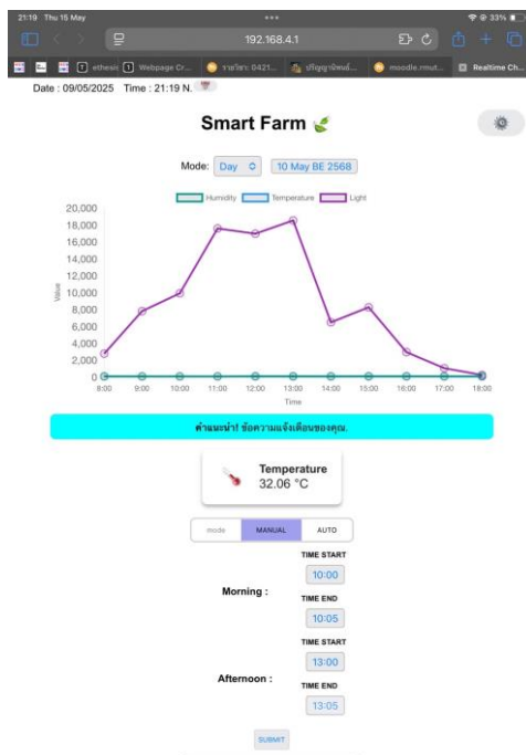
รูปที่ 3.33 การทดสอบสั่งการทำงานในโหมด Manual ผ่านเว็บไซต์ฟเวอร์
