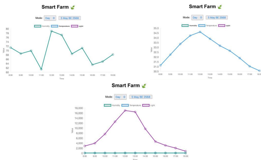
รูปที่ 4.52 กราฟแสดงค่าความชื้นสัมพัทธ์ (เปอร์เซ็นต์) ค่าอุณหภูมิ (องศาเซลเซียส) และค่าความเข้มแสง (ลักซ์) วันที่ 5 พฤษภาคม 2568 (วันที่ 2 ในการเก็บค่า)
