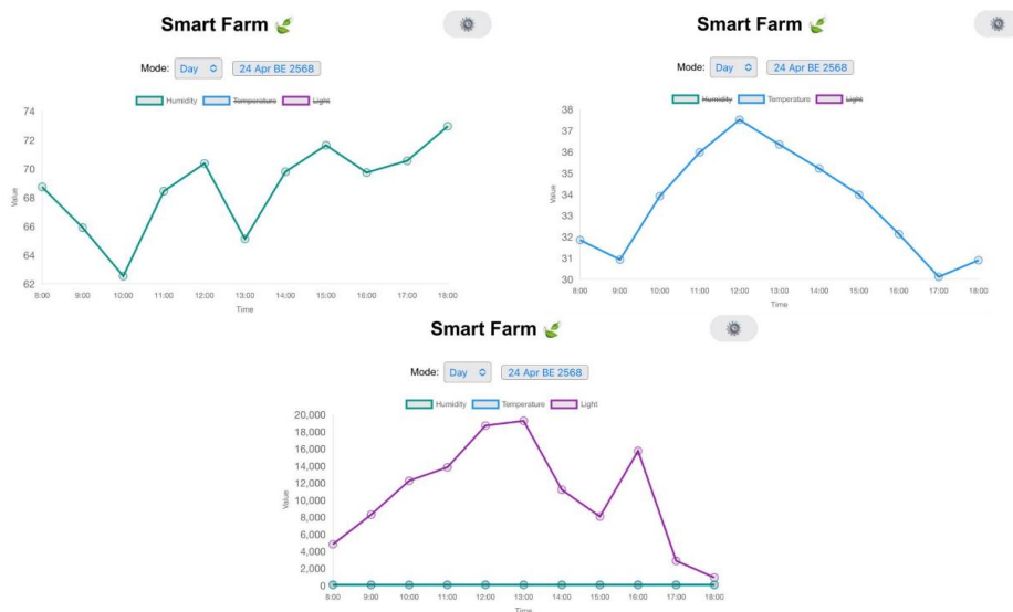
รูปที่ 4.42 กราฟแสดงค่าความชื้นสัมพัทธ์ (เปอร์เซ็นต์) ค่าอุณหภูมิ (องศาเซลเซียส) และค่าความเข้มแสง (ลักซ์) วันที่ 24 เมษายน 2568 (วันที่ 6 ในการเก็บค่า)
