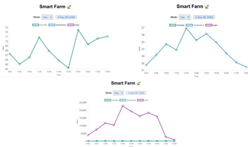
รูปที่ 4.51 กราฟแสดงค่าความชื้นสัมพัทธ์ (เปอร์เซ็นต์) ค่าอุณหภูมิ (องศาเซลเซียส) และค่าความเข้มแสง (ลักซ์) วันที่ 4 พฤษภาคม 2568 (วันที่ 1 ในการเก็บค่า)
