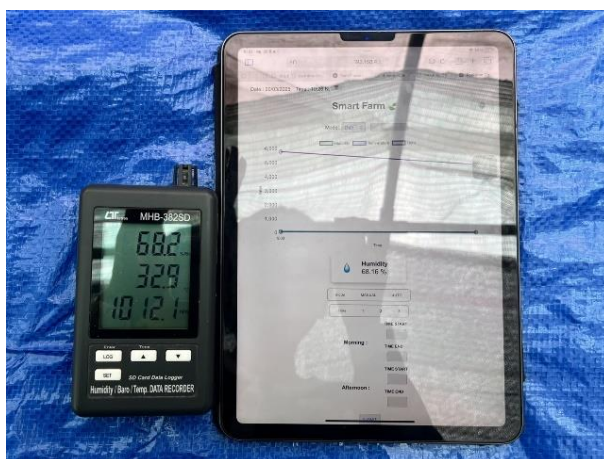
รูปที่ 3.26 การทดสอบเปรียบเทียบความชื้นสัมพัทธ์ภายในโรงเรือนจากตัววัดด้วยตัวตรวจรู้ BME-280 กับมิเตอร์ Lutron MHB-382SD
