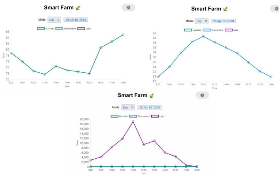
รูปที่ 4.43 กราฟแสดงค่าความชื้นสัมพัทธ์ (เปอร์เซ็นต์) ค่าอุณหภูมิ (องศาเซลเซียส) และค่าความเข้มแสง (ลักซ์) วันที่ 25 เมษายน 2568 (วันที่ 7 ในการเก็บค่า)
