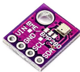
รูปที่ 2.5 เซ็นเซอร์ BME280
