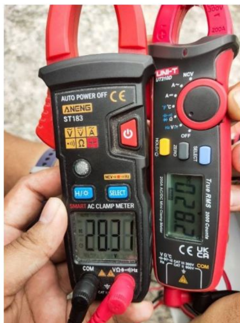
รูปที่ 4.18 เปรียบเทียบมัลติมิเตอร์ที่ใช้กับมัลติมิเตอร์ที่มีความน่าเชื่อถือ
