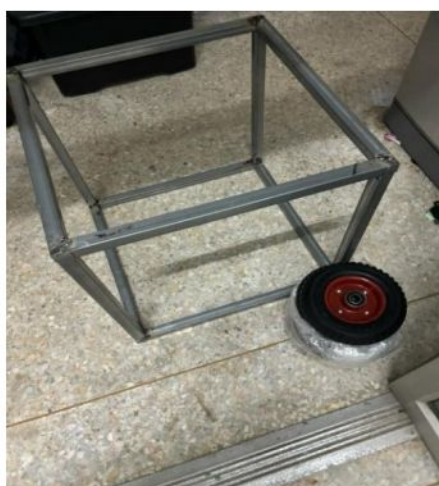
รูปที่ 3.26 นำเหล็กที่ตัดไว้มาเชื่อมจะได้โครงสร้างตัวถังของตัวรถ
