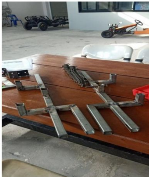
รูปที่ 3.27 โครงสร้างของชุดขับเคลื่อนโดยใช้ตีนตะขาบ
