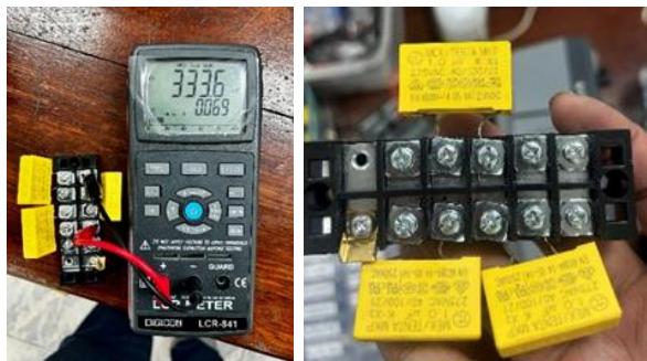
ภาพที่ 5-29 ตัวเก็บประจุขนาด 1.0 \mu\text{F} มาอนุกรมกัน 3 ตัวเพื่อให้ได้ขนาด 0.334 \mu\text{F}
