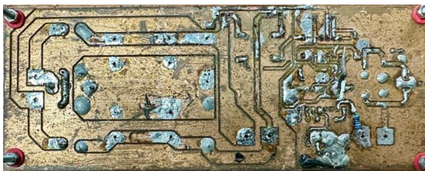
ภาพที่ 5-12 แผ่น PCB แบบกัตลายปริ้นที่มีการหลุดลอก
