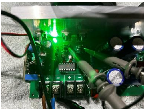
ภาพที่ 5-16 การวัดสัญญาณที่ออกจาก Gate Driver
