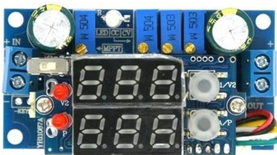
ภาพที่ 5-36 DC MPPT Controller 5A DC-DC Step Down
