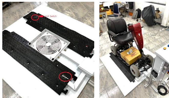
ภาพที่ ฉ-5 ล้อทั้งสองข้างกดสวิตช์ Limit Switch
