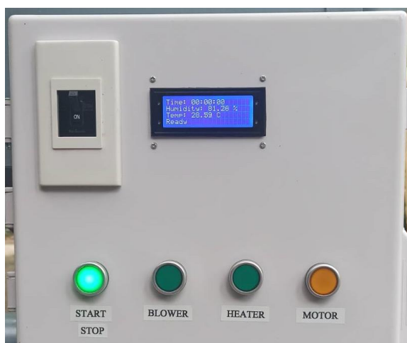
รูปที่ 3.38 หน้ากล่องควบคุมที่แสดงเวลาการทำงาน , ความชื้น, อุณหภูมิ
