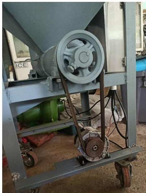
รูปที่ 3.8 มอเตอร์เมื่อติดตั้งเข้ากับแกนใบเกลียวหมุน
