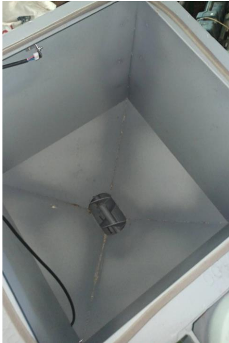
รูปที่ 3.7 แกนใบเกลียวหมุนเมื่อนำไปติดตั้งในตัวท่อใบเกลียวหมุน
