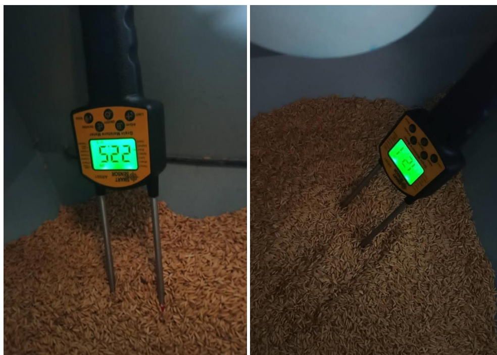
รูปที่ 4.4 การวัดความชื้นก่อน - หลัง ด้วย Smart Sensor AR991 ภายในถังเก็บข้าวเปลือก ครั้งที่ 2
