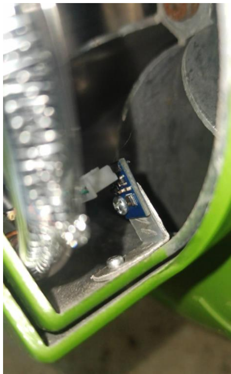
รูปที่ 3.11 เซ็นเซอร์ AHT30 ควบคุมอุณหภูมิของฮีตเตอร์ที่ติดตั้งทางเข้าอากาศภายใน พัฒนแบบแรงเหวี่ยง
