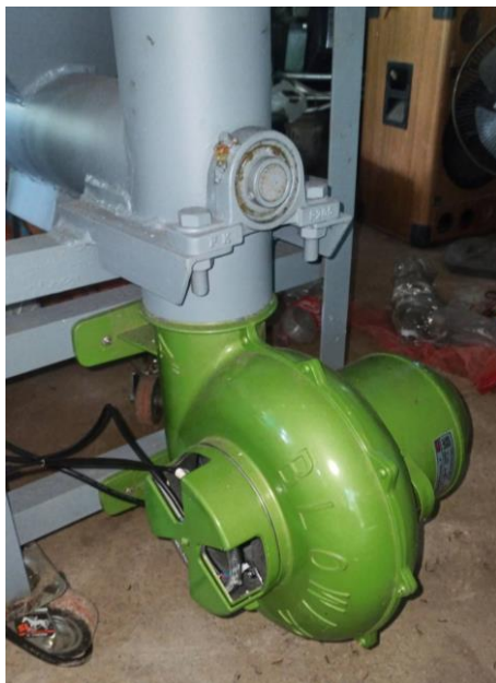
รูปที่ 3.9 พัฒนแบบแรงเหวี่ยงเมื่อติดตั้งกับตัวเครื่อง
