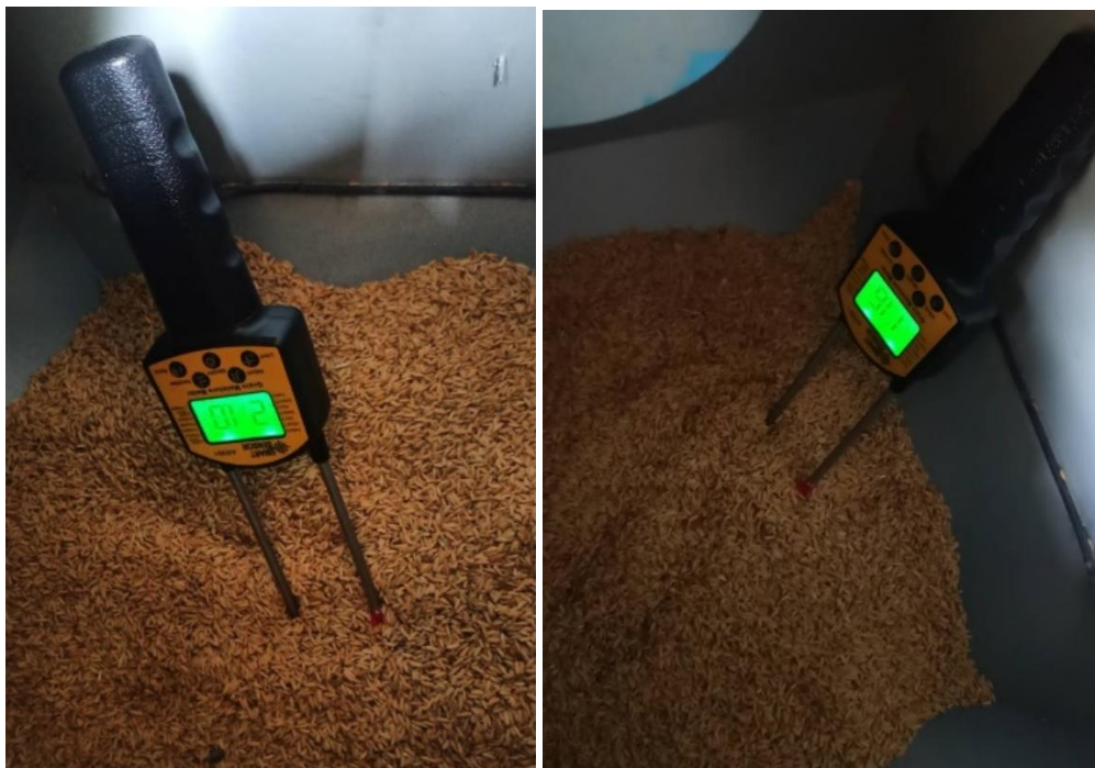
รูปที่ 4.3 การวัดความชื้นก่อน - หลัง ด้วย Smart Sensor AR991 ภายในถังเก็บข้าวเปลือก ครั้งที่ 1
