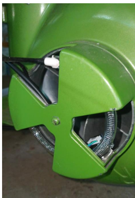
รูปที่ 3.10 ฮีตเตอร์เมื่อติดตั้งทางเข้าอากาศภายในพัฒนแบบแรงเหวี่ยง
