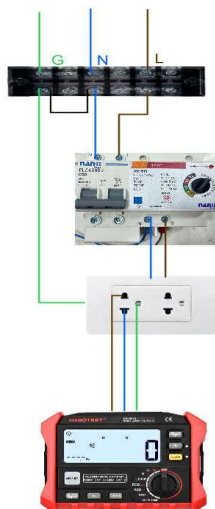
ภาพที่ 4-7 การต่อใช้งาน RCD กับเครื่อง Habotest HT5910
