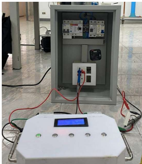
ภาพที่ 4-12 การต่อใช้งานจริงเครื่องทดสอบเครื่องตัดไฟรั่วด้วยไมโครคอนโทรลเลอร์
