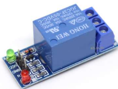
ภาพที่ 3-6 Relay module 5V 1 chanel 250V/10A
