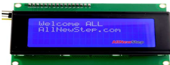
ภาพที่ 3-7 จอ LCD ขนาด 20x4
