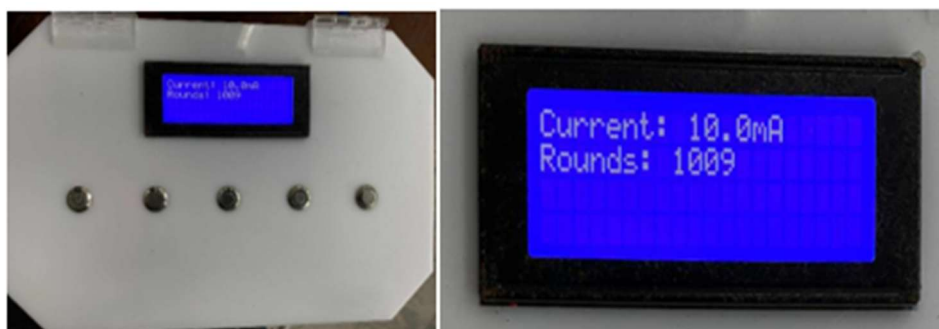
ภาพที่ 3-15 จำนวนรอบการหมุนของโหลดความต้านทานปรับค่าได้
