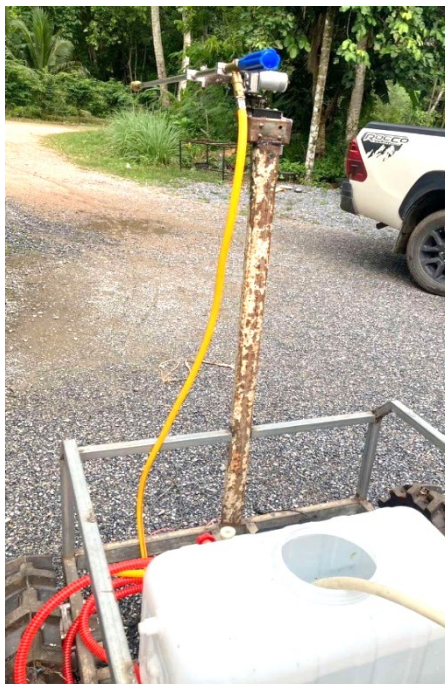
รูปที่ 5.1 เสาดเหล็กที่ส่นขณะรถเคลื่อนที่
