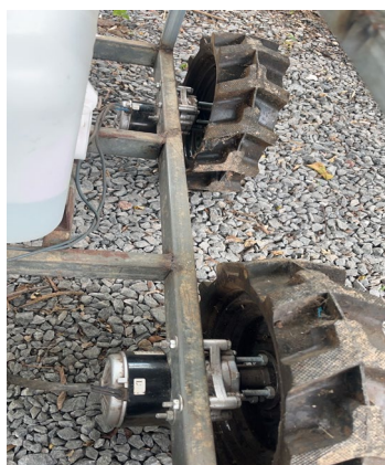
รูปที่ 3.12 ติดตั้งมอเตอร์ทดเกียร์เข้ากับโครงสร้างรถและชุดล้อ
