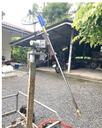
รูปที่ 3.14 ติดตั้งก้านพ่นสารเคมี
