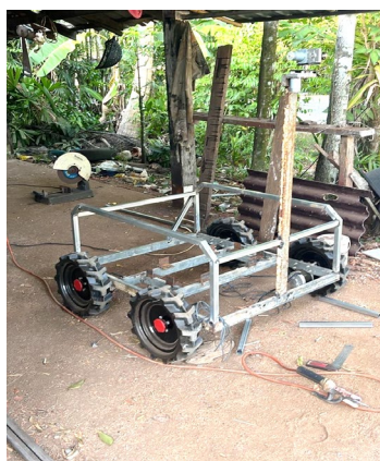
รูปที่ 3.11 ประกอบโครงสร้างรถพ่นสารเคมีสำหรับพืชสวนยืนต้นควบคุมด้วยรีโมทคอนโทรล
