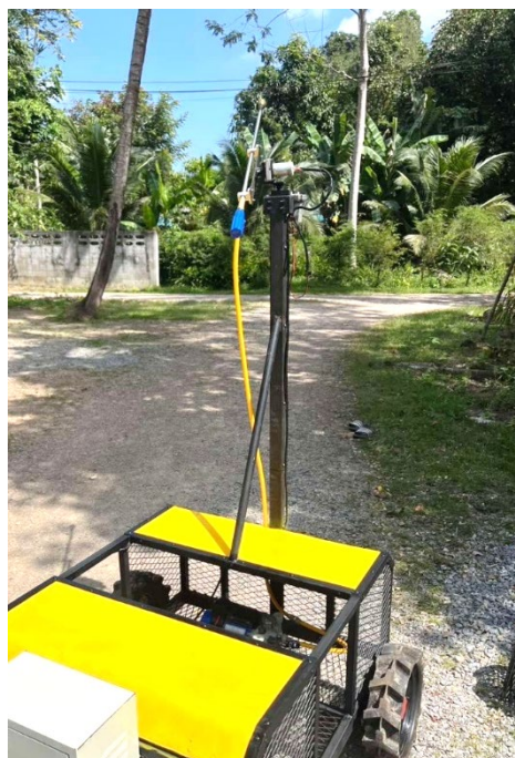
รูปที่ 5.2 หลังจากนำเหล็กมาเชื่อมค้ำเสาไว้
