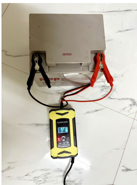
รูปที่ 4.19 การชาร์จแบตเตอรี่ชุดล้อ
