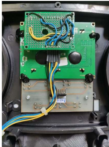
ภาพที่ 3-19 ติดตั้งหน้าจอแสดงผลและชุดคำสั่ง Input
