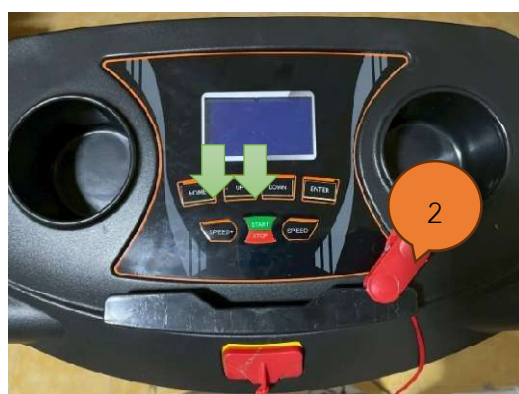
ภาพที่ ข-2 ทำการติด Safety switch
