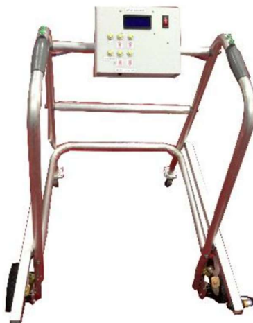
ภาพที่ 2-2 เครื่องช่วยเดินอัตโนมัติ นายจรูญ คนแรง คณะเทคโนโลยีอุตสาหกรรม [4]
