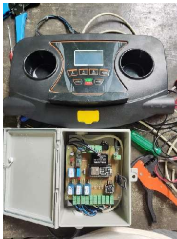
ภาพที่ 3-20 ติดตั้งวงจรชุดคำสั่งหลักเข้ากับกล่อง Box electric
