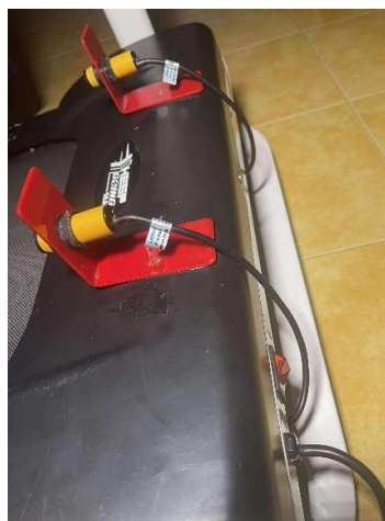
ภาพที่ 3-22 ติดตั้ง IR sensor1 และ IR sensor2
