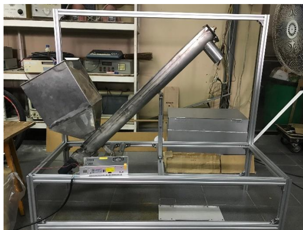
ภาพที่ 3-9 เครื่องลำเลียงแบบเกลียวสกรู ขนาดความยาวท่อลำเลียง 900 mm.
