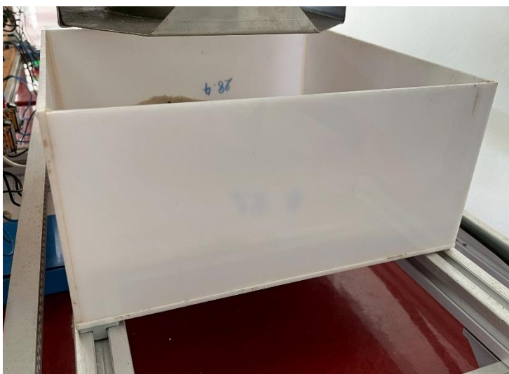
ภาพที่ 3-26 ทำการติดตั้งโปรไฟล์อลูมิเนียมตรงฐานเพิ่มเติมและติดตั้งกล่องถ่ายวัสดุ
