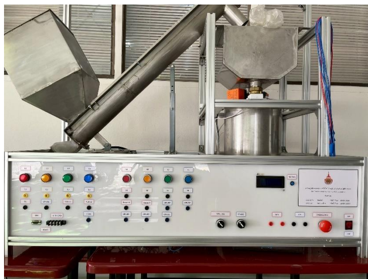
ภาพที่ 3-28 ทำการใส่แผ่นอะคริลิกขนาด 123*28 ซม.หนา 7 มม. ที่เจาะรูพร้อมติดตั้งอุปกรณ์ด้านหน้าของชุดฝึก
