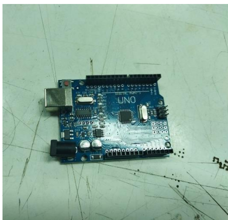
ภาพที่ 3-16 Arduino UNO R3
