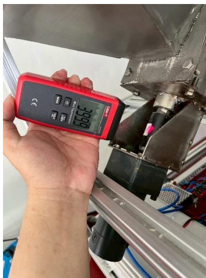
ภาพที่ 4-9 ใช้เครื่องมือวัดความเร็วรอบ(Tachometer) วัดความเร็วรอบของมอเตอร์
