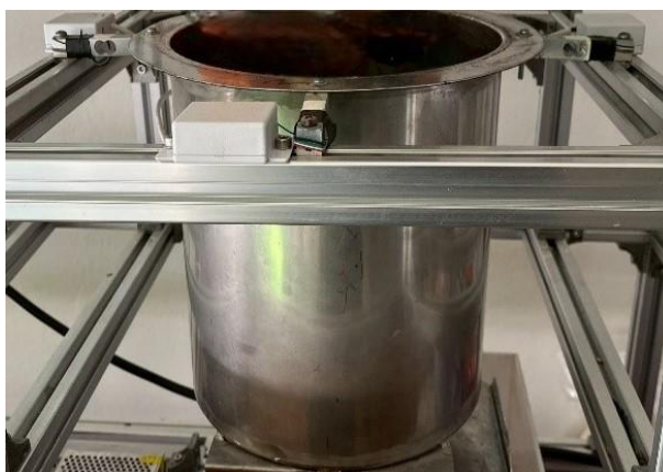
ภาพที่ 3-24 นำโหลดเซลล์และถังชั่งมาติดตั้งบนโครงอลูมิเนียมโปรไฟล์
