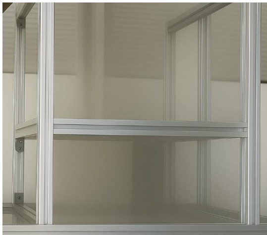
ภาพที่ 3-23 นำอลูมิเนียมโปรไฟล์มาติดตั้งเพิ่มเติม เพื่อวางชุดชั่งน้ำหนัก ถังชั่ง และถังพัก
