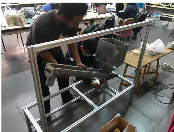
ภาพที่ 3-22 นำเครื่องลำเลียงที่มีคอนเวเยอร์แบบเกลียวสกรูมายึดติดกับโครงอลูมิเนียมโปรไฟล์
