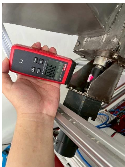
ภาพที่ 4-3 ใช้เครื่องมือวัดความเร็วรอบ(Tachometer) วัดความเร็วรอบของมอเตอร์
