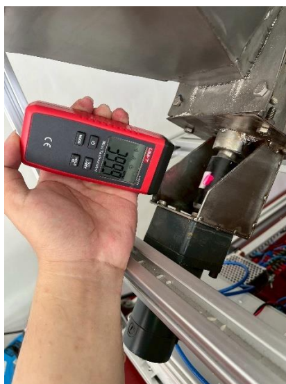
ภาพที่ 4-6 ใช้เครื่องมือวัดความเร็วรอบ(Tachometer) วัดความเร็วรอบของมอเตอร์
