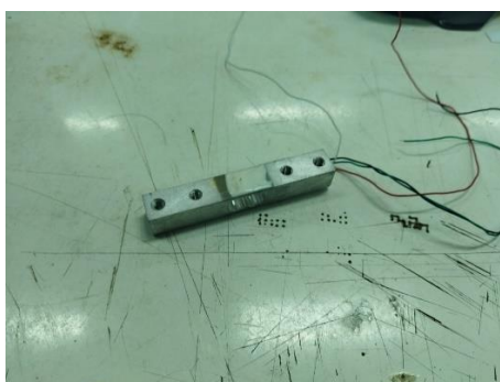
ภาพที่ 3-11 โหลดเซลล์ ขนาดพิกัด 10 กิโลกรัม
