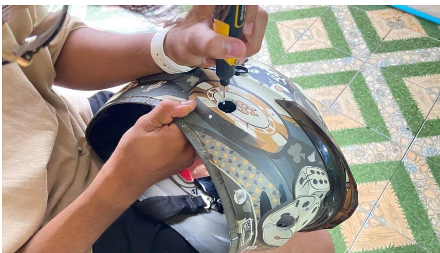
ภาพที่ 3 – 28 แสดงขั้นตอนการเจาะหมวกเพื่อเตรียมติดตั้งเซนเซอร์
