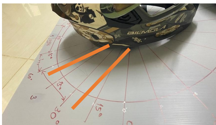
ภาพที่ 3 - 23 แสดงการวางตำแหน่งหมวกกันน็อคบนแผ่นองศาสำหรับประเมินมุมการตรวจจับ
