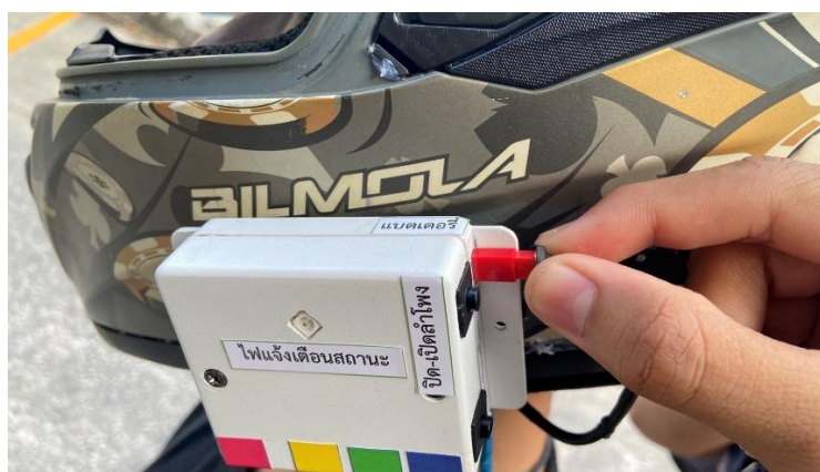
ภาพที่ 4-3 แสดงขั้นตอนการเสียบสายไฟเข้ากับกล่องควบคุมระบบ เพื่อเริ่มต้นการจ่ายไฟให้กับ ESP32-S และอุปกรณ์ทั้งหมด
