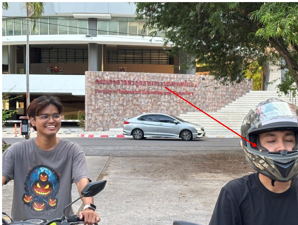
ภาพที่ 4-6 แสดงการขับเข้าใกล้ในมุมด้านขวาของหมวก เพื่อทดสอบเซนเซอร์ฝั่งขวา
