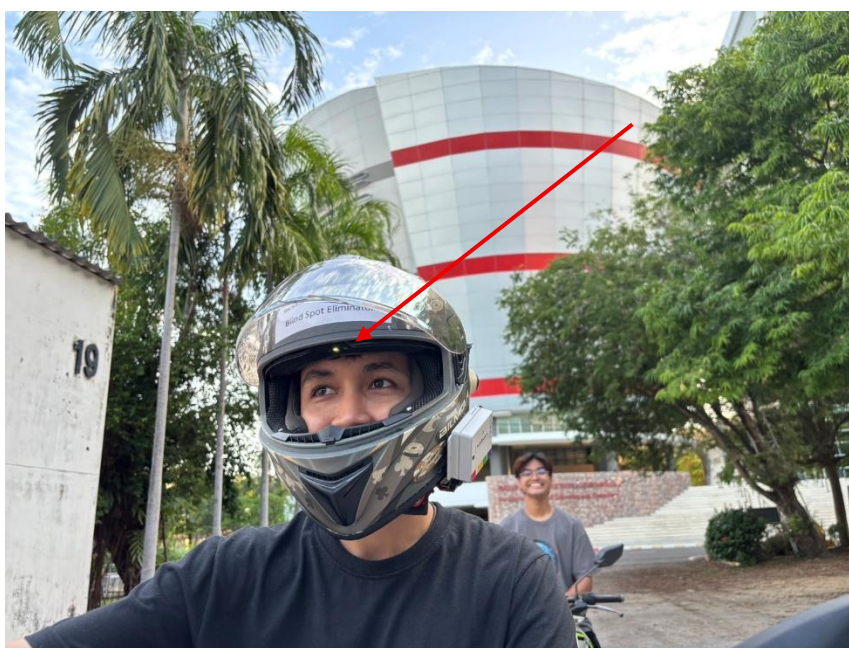
ภาพที่ 4-7 แสดงการขับเข้าใกล้ด้านหลังของหมวกในแนวตรง เพื่อทดสอบเซนเซอร์ด้านหลัง
