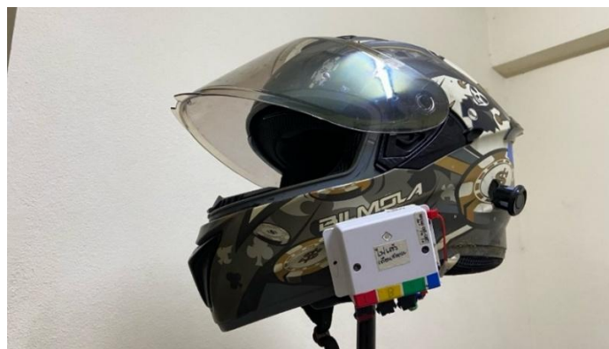
ภาพที่ 3-38 แสดงการติดตั้งกล่องควบคุมและเซนเซอร์อัลตราโซนิกบนหมวกกันน็อกสำหรับตรวจจับและแจ้งเตือนอุบัติเหตุ
