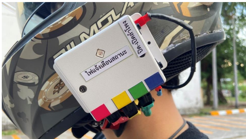
ภาพที่ 4-4 แสดงกล่องควบคุมที่เชื่อมต่อสายไฟและอุปกรณ์เรียบร้อย พร้อมสำหรับใช้งานภาคสนาม
