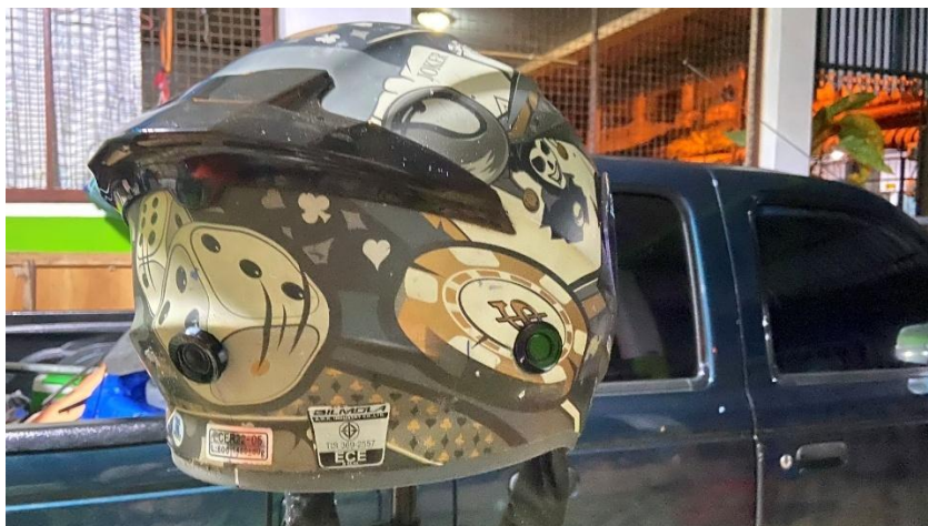
ภาพที่ 3 - 31 แสดงการติดตั้งเซนเซอร์อัลตราโซนิก
