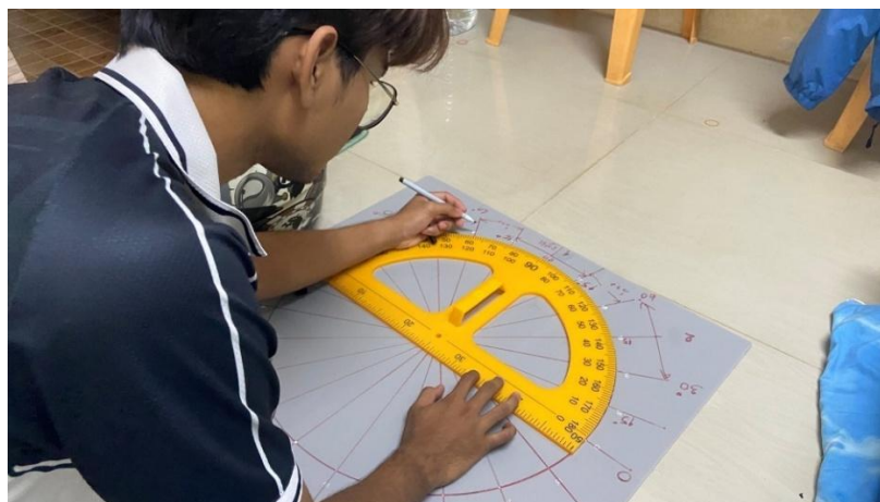
ภาพที่ 3 – 21 แสดงขั้นตอนการกำหนดองศาตรวจจับของเซนเซอร์
