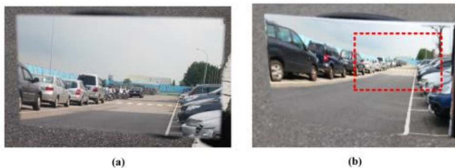
ภาพที่ 2 - 12 Reflective images of (a) a flat mirror and (b) a freeform reflector
