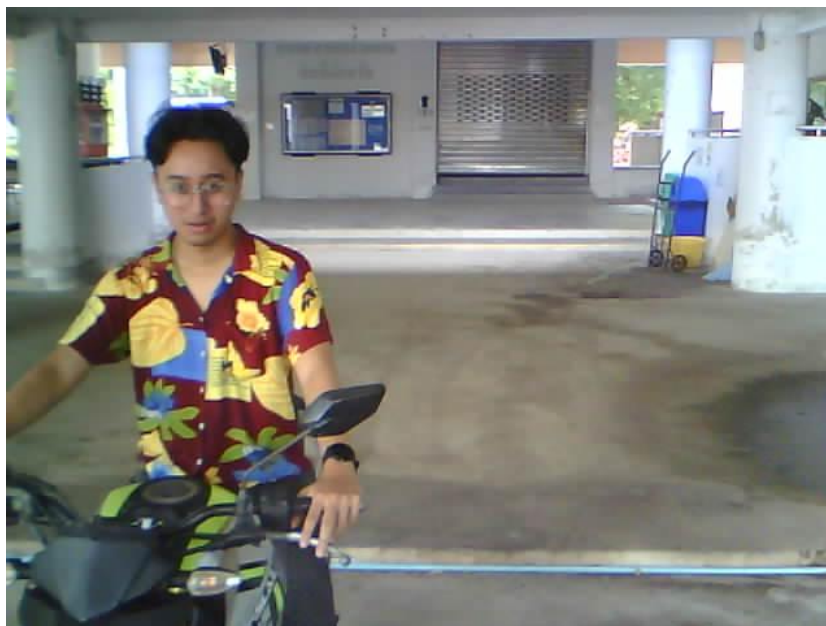
ภาพที่ 3 - 43 ภาพจากกล้อง ESP32-CAM เมื่อมีวัตถุเข้าสู่ระยะ 300 ซม.
