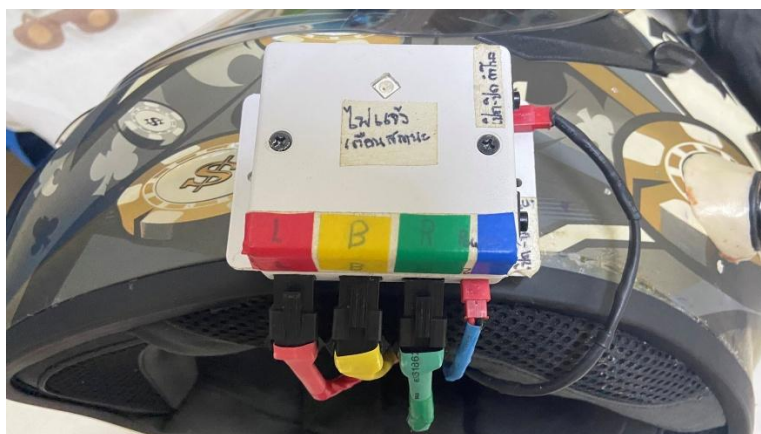
ภาพที่ ก-1 กล่องควบคุมหลักพร้อมสายเชื่อมต่อเซนเซอร์และจ่ายไฟเข้าสู่ระบบ
