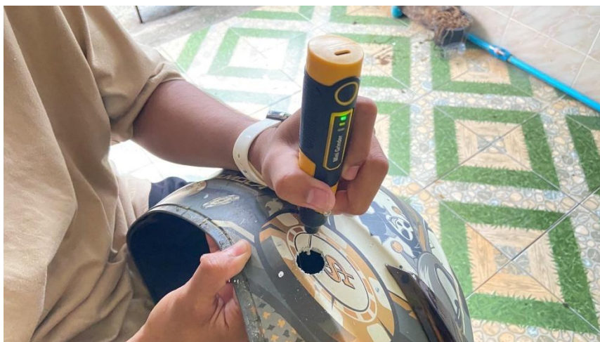
ภาพที่ 3 - 29 แสดงขั้นตอนการเจาะหมวกเพื่อเตรียมติดตั้งเซนเซอร์
