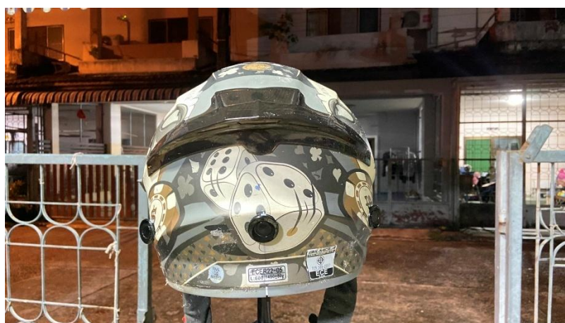
ภาพที่ 3 - 32 แสดงการติดตั้งเซนเซอร์อัลตราโซนิก
