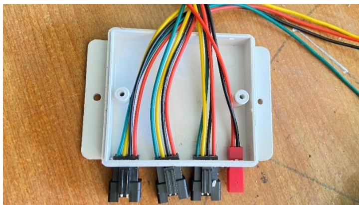
ภาพที่ 3 – 33 แสดงกล่องควบคุมที่จัดเตรียมสายไฟสำหรับเชื่อมต่อกับเซนเซอร์และอุปกรณ์ต่าง ๆ
