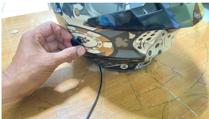
ภาพที่ 3 - 30 แสดงการติดตั้งเซนเซอร์อัลตราโซนิก
