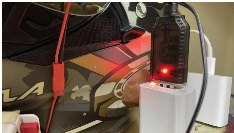
ภาพที่ ก-4 สายชาร์จแบตเตอรี่แบบ JST กำลังชาร์จผ่านพอร์ต USB (ไฟสถานะสีแดง)
