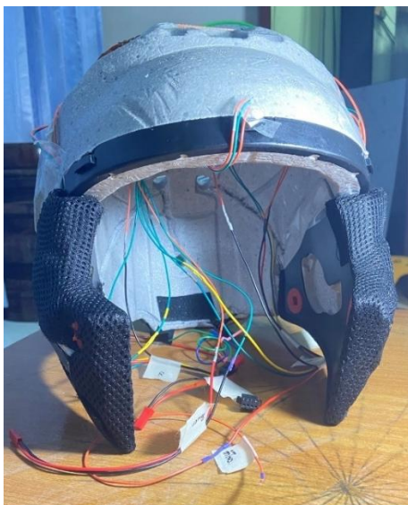
ภาพที่ 3 – 37 เดินสายเซนเซอร์จากหมวกเข้าสู่กล่องควบคุม
