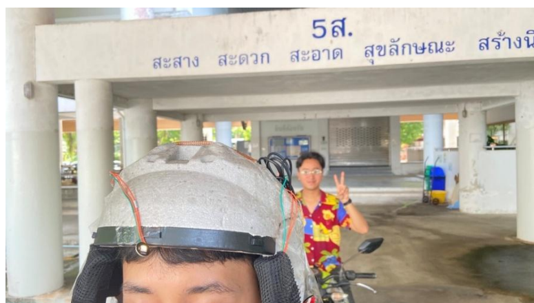
ภาพที่ 3 - 42 แสดงการทดสอบระบบในสถานการณ์จริงเมื่อมีวัตถุเข้าใกล้จากด้านหลัง
