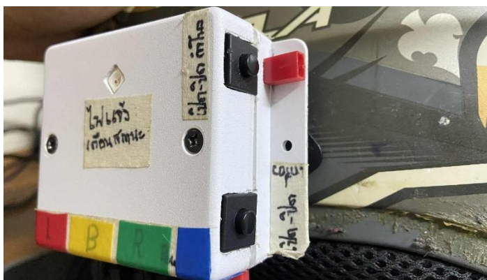
ภาพที่ ก-2 กล่องควบคุมหลักพร้อมสวิตช์เปิด-ปิดระบบ ที่ติดตั้งบริเวณด้านหลังหมวกกันน็อก
