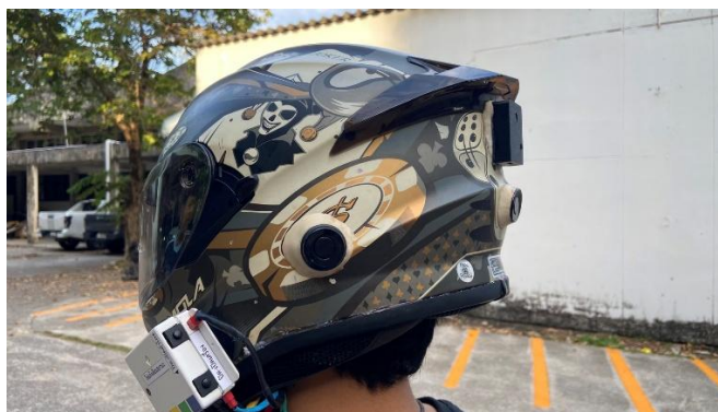
ภาพที่ 4-1 แสดงการติดตั้งเซนเซอร์อัลตราโซนิกด้านซ้ายและขวามุมอับสายตา เพื่อใช้ตรวจจับวัตถุ ในมุมอับสายตาทั้งสองด้าน
