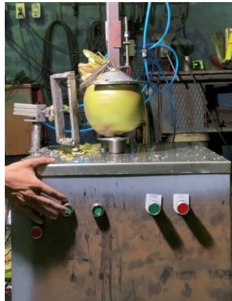
รูปที่ 3.18 การปอกด้านกันของเครื่องปอกเปลือกมะพร้าวน้ำหอมอัตโนมัติ
