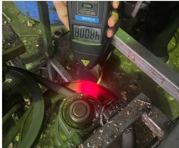
รูปที่ 4.1 ความเร็วรอบมู่เลย์ชุดฝั่มมอเตอร์
