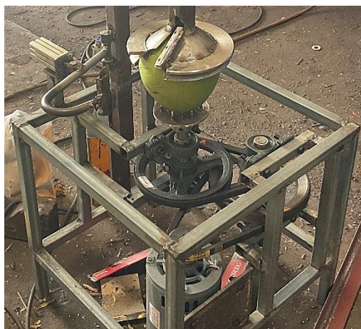
รูปที่ 3.13 ทดสอบความเร็วรอบของมอเตอร์
