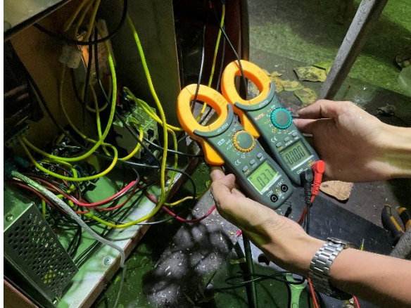
รูปที่ 3.16 ทดสอบวัดกระแสไฟฟ้าขณะทำการปอก
