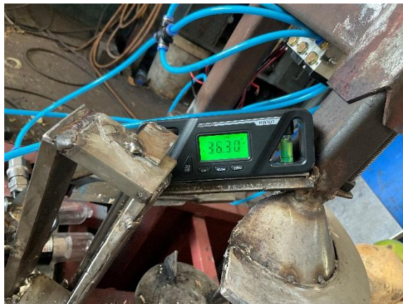
รูปที่ 3.14 ทดสอบองศาการวางมีด
