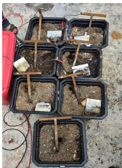
ภาพที่ 4-3 สภาพชิ้นเหล็กจากการทดลอง 30 วัน
