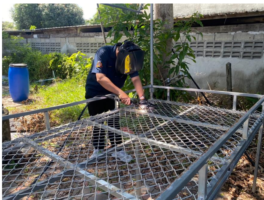
ภาพที่ 3.11 ทำการเชื่อมตระแกรงเพื่อเพิ่มการรับน้ำหนักของดินให้มีประสิทธิภาพมากยิ่งขึ้น
