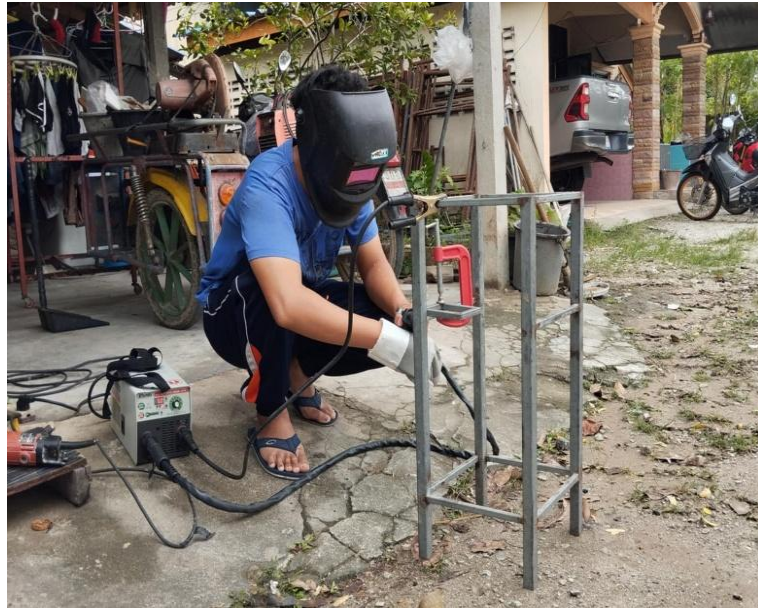
รูปที่ 3-26 เชื่อมเหล็กเพื่อประกอบเป็นโครงสร้างสำหรับรองรับน้ำหนักของถังน้ำมัน
