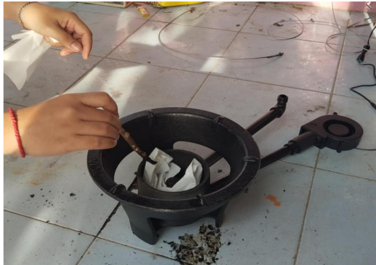
รูปที่ 4-48 วางวัสดุเชื้อเพลิงลงในเตา เพื่อเป็นตัวจุดติดไฟ
