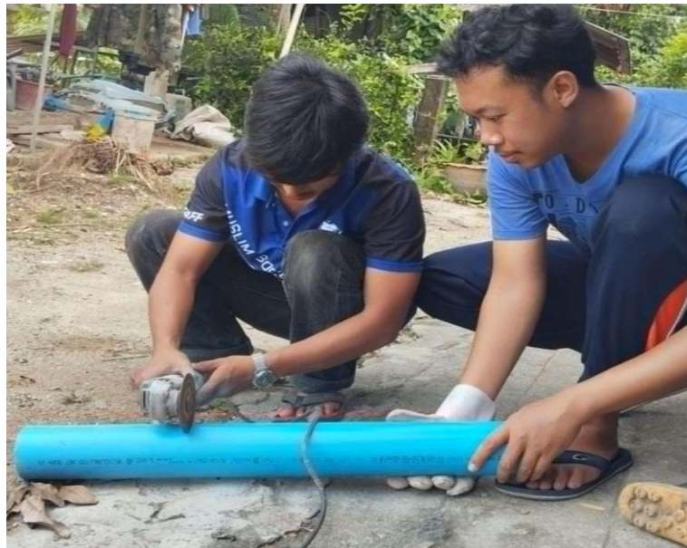
รูปที่ 3-39 วัดและตัดท่อ PVC ให้ได้ขนาดตามที่คำนวณไว้สำหรับใช้เป็นภาชนะบรรจุน้ำมัน
