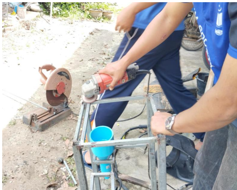
รูปที่ 3-29 ทำการเจียรเหล็กเพื่อให้ได้พื้นผิวที่ได้ระดับ
