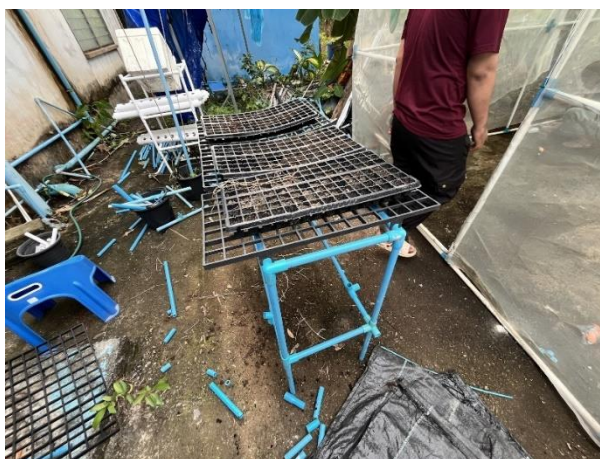
รูปที่ 3.9 ออกแบบฐานวางถาดเพาะปลูกต้นกล้าภายในโรงเรือน
