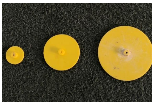
รูปที่ 3.17 จานหมุนเหวี่ยงรดน้ำ 3 ขนาด 3 เซนติเมตร 6 เซนติเมตร และ 9 เซนติเมตร ตามลำดับ
