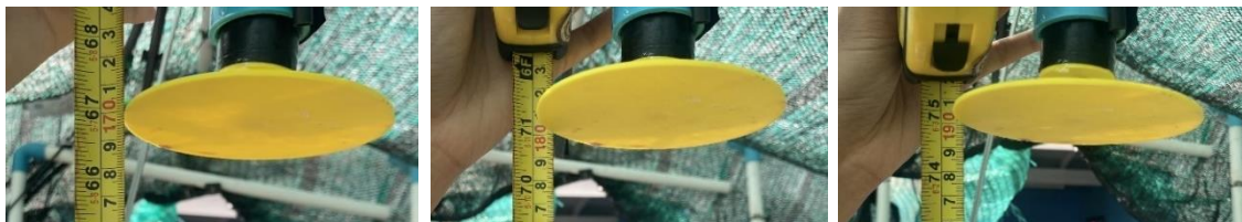
รูปที่ 3.18 งานหมุนเหวี่ยงรดน้ำความสูง 3 ระดับ 170 เซนติเมตร, 180 เซนติเมตร และ 190 เซนติเมตร ตามลำดับ
