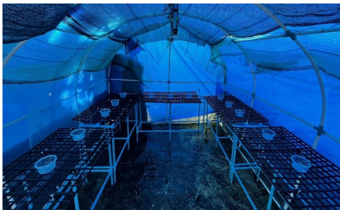
รูปที่ 3.19 การทดสอบการกระจายน้ำเพื่อหาปริมาณน้ำแต่ละจุด จำนวน 5 จุด
