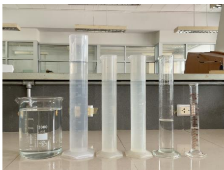
รูปที่ 3.16 การทดสอบอัตราการไหลของปั้มน้ำเพื่อวัดปริมาณน้ำที่ออกจากหัวจ่าย (2 หัวจ่าย)
