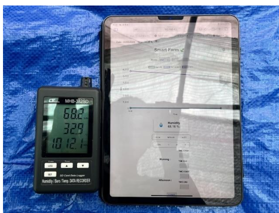
รูปที่ 3.23 การทดสอบเปรียบเทียบความชื้นสัมพัทธ์ภายในโรงเรือนจากตัววัดด้วยตัวตรวจรู้ BME-280 กับมิเตอร์ Lutron MHB-382SD
