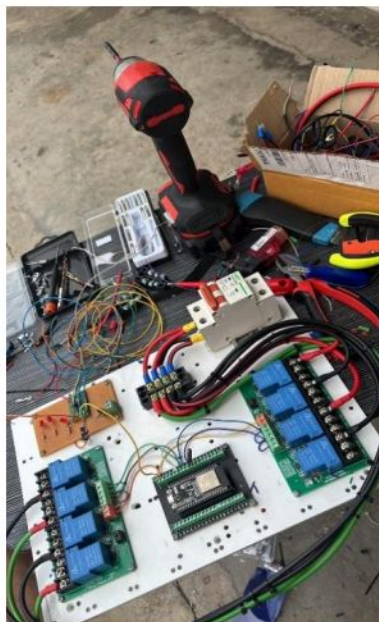
ภาพที่ 3-42 ประกอบอุปกรณ์ต่างๆของวงจรคอนโทรล
