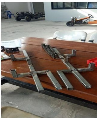
ภาพที่ 3-33 โครงสร้างของชุดขับเคลื่อนโดยใช้ดินตะขาบ
