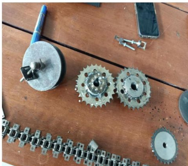
ภาพที่ 3-34 กลึงชุดโรลเลอร์และชุดเฟืองล้อขับเคลื่อน
