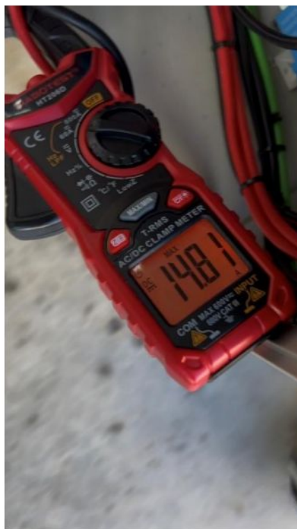
ภาพที่4-12 ทดสอบกระแสขณะมีโหลด
