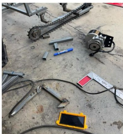
ภาพที่ 3-37 หาตำแหน่งวางมอเตอร์ซึ่งใช้เป็นตัวส่งกำลังขับเคลื่อน
