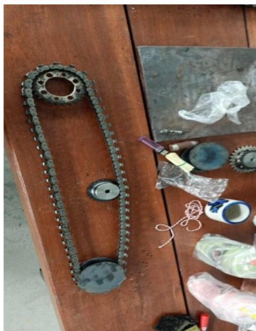
ภาพที่ 3-35 โซ่สร้างซึ่งใช้เป็นสายพานขับเคลื่อนชุดล้อ
