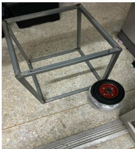
ภาพที่ 3-32 นำเหล็กที่ตัดไว้มาเชื่อมจะได้โครงสร้างตัวถังของตัวรถ
