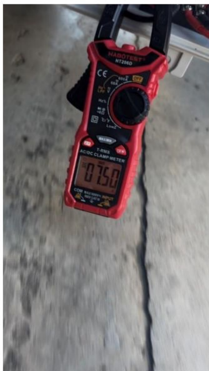
ภาพที่ 4-11 ทดสอบกระแสขณะไม่มีโหลด
