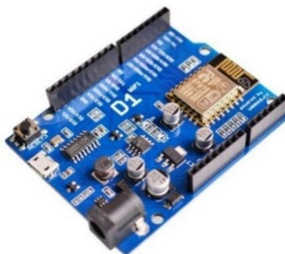
ภาพที่ 3-35 WEMOS D1 R2 WIFI ESP8266 Shield Arduino Compatible
