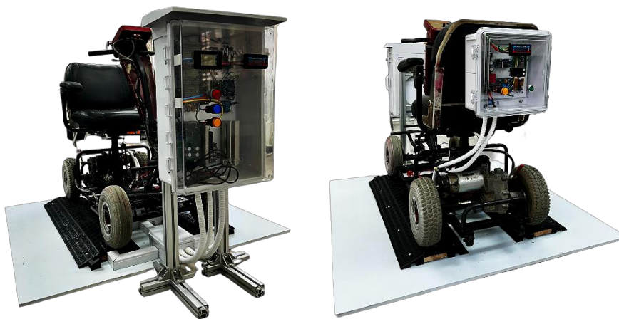
ภาพที่ 4-13 ชุดสาธิตระบบการถ่ายโอนพลังงานไฟฟ้าแบบไร้สายสำหรับยานยนต์ไฟฟ้า
