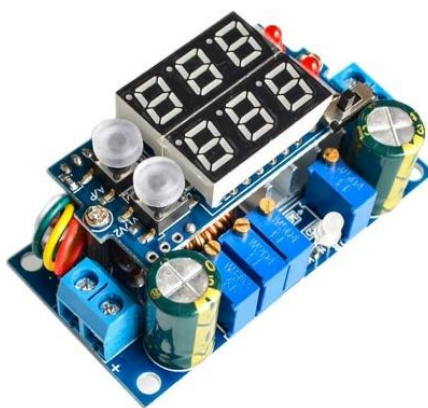
ภาพที่ 3-51 DC MPPT Controller 5A DC-DC Step Down
