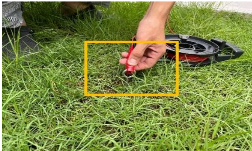
ภาพที่ 2-6 ระยะห่างจากหลักดิน 10 เมตร สายสีแดงจะเป็นสายที่ปล่อยกระแส [3]
