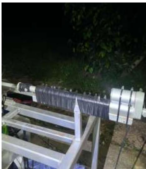
ภาพที่3-9 ติดตั้งลิ้นชักมอเตอร์เข้ากับโครงสร้างเครื่องฉีด
