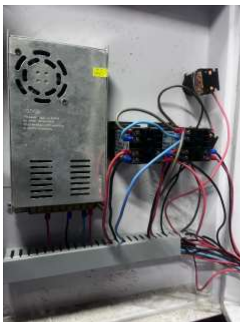
ภาพที่ 3-13 ระบบควบคุมความร้อนและแสดงค่าอุณหภูมิของกระบอกฉีดและกระบอกเก็บพลาสติก
