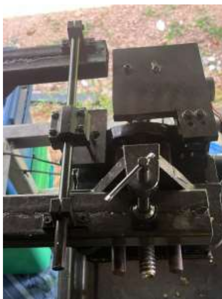
ภาพที่ 3-11 ติดตั้งระบบเปิดแม่พิมพ์พลาสติก
