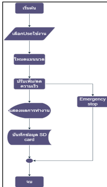
ภาพที่ 3.12 กระบวนการทำงานของโหมดแมนนวลของลู่วิ่งสำหรับผู้ป่วยและผู้สูงอายุ
