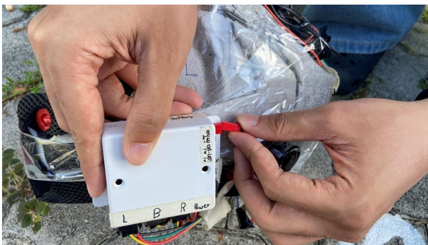
รูปที่ 4-3 แสดงขั้นตอนการเสียบสายไฟเข้ากับกล่องควบคุมระบบ เพื่อเริ่มต้นการจ่ายไฟให้กับ ESP32-S และอุปกรณ์ทั้งหมด
