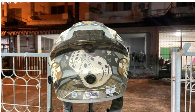
รูปที่ 3 - 32 แสดงการติดตั้งเซนเซอร์อัลตราโซนิก
