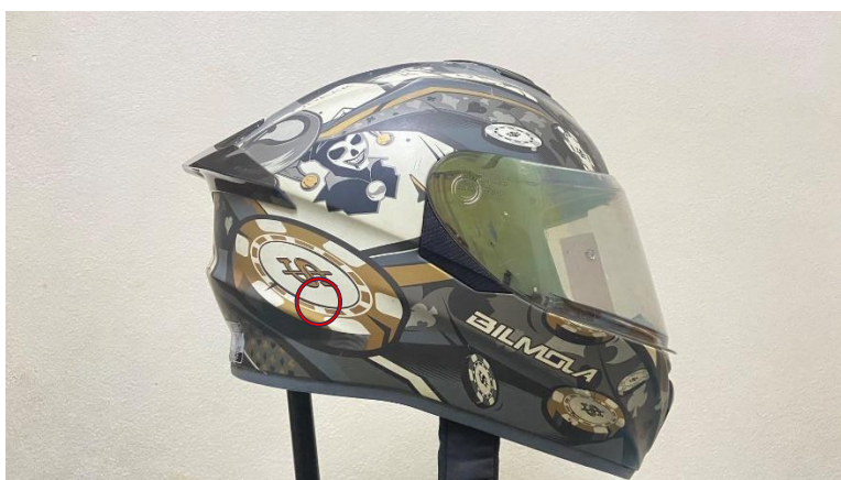
รูปที่ 3 - 26 แสดงด้านขวาของหมวกกันน็อค สำหรับติดตั้งเซนเซอร์ตรวจจับวัตถุด้านขวา
