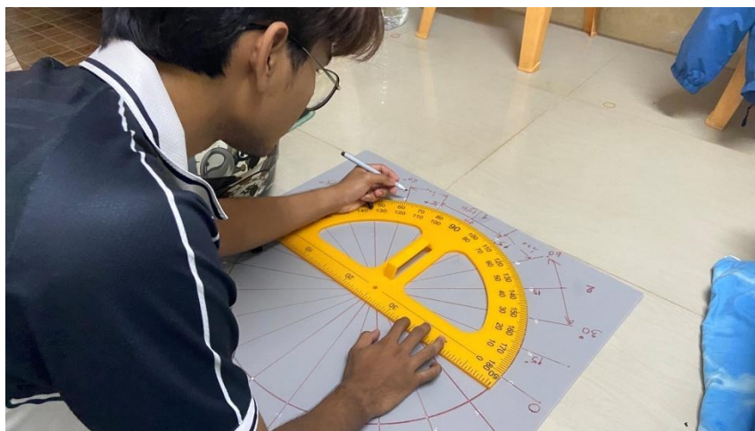
รูปที่ 3 – 21 แสดงขั้นตอนการกำหนดองศาตรวจจับของเซนเซอร์
