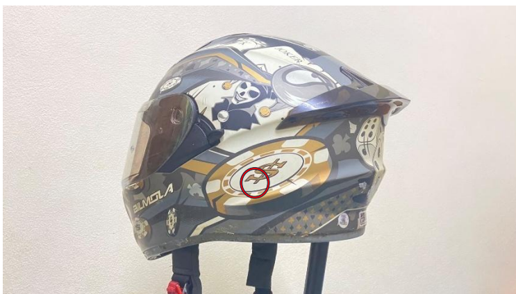
รูปที่ 3 - 25 แสดงด้านซ้ายของหมวกกันน็อค สำหรับติดตั้งเซนเซอร์ตรวจจับวัตถุด้านซ้าย
