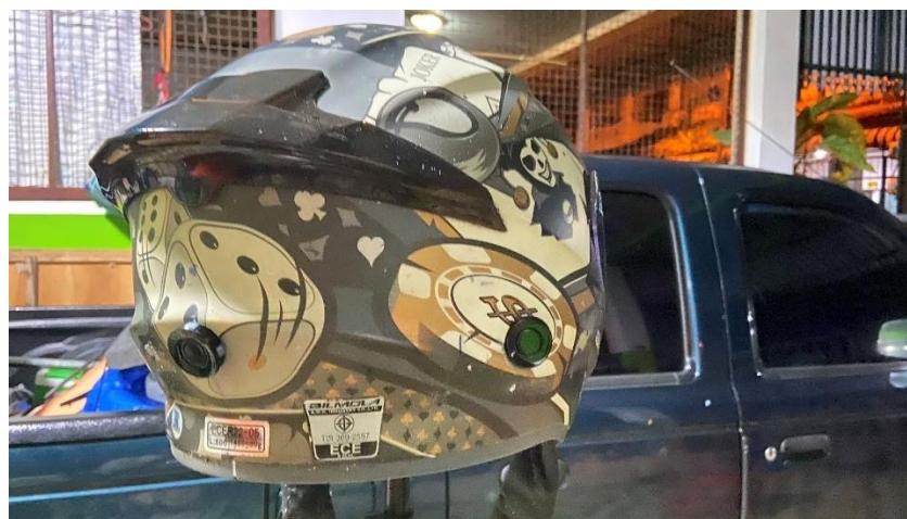
รูปที่ 3 - 31 แสดงการติดตั้งเซนเซอร์อัลตราโซนิก
