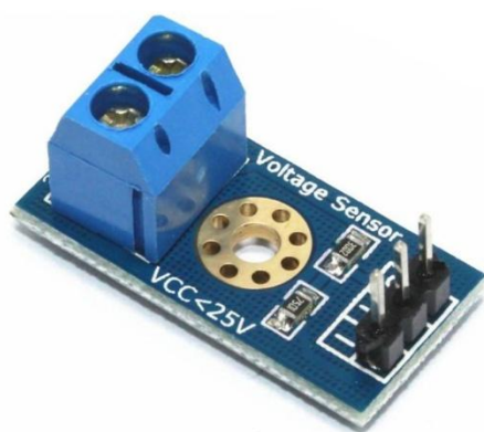
รูปที่ 2 - 18 Voltage Sensor Module
