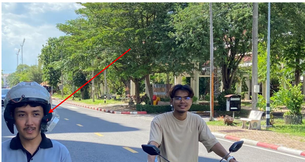
ภาพที่ 4-6 แสดงการขับเข้าใกล้ในมุมด้านขวาของหมวก เพื่อทดสอบเซนเซอร์ฝั่งขวา
