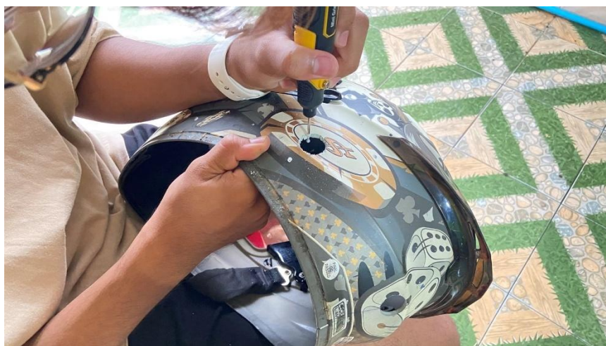
รูปที่ 3 - 28 แสดงขั้นตอนการเจาะหมวกเพื่อเตรียมติดตั้งเซนเซอร์
