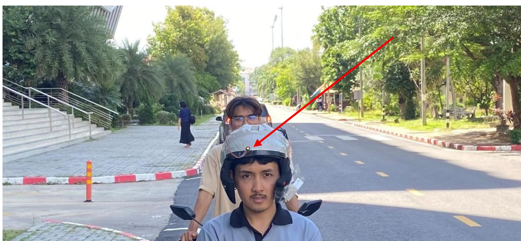
ภาพที่ 4-7 แสดงการขับเข้าใกล้ด้านหลังของหมวกในแนวตรง เพื่อทดสอบเซนเซอร์ด้านหลัง
