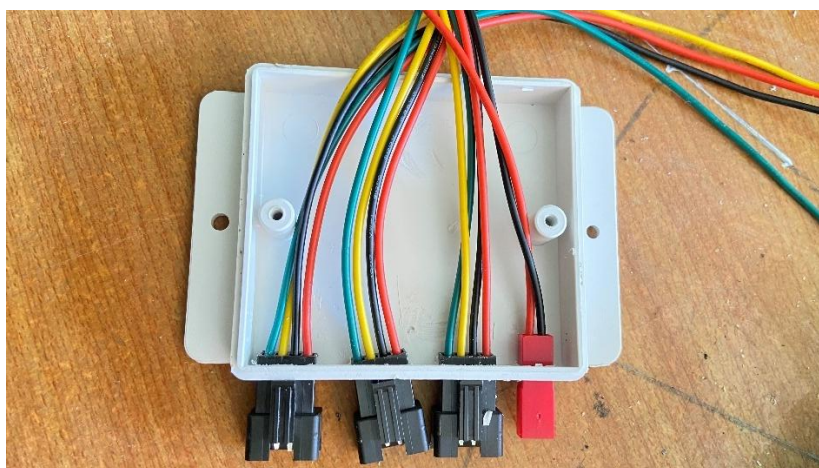
รูปที่ 3 - 33 แสดงกล่องควบคุมที่จัดเตรียมสายไฟสำหรับเชื่อมต่อกับเซนเซอร์และอุปกรณ์ต่าง ๆ
