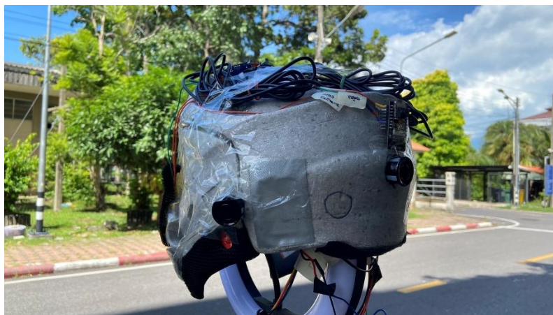
รูปที่ 4-1 แสดงการติดตั้งเซนเซอร์อัลตราโซนิกด้านซ้ายและขวามุมหมวกกันน็อก เพื่อใช้ตรวจจับวัตถุในมุมอันตรายทั้งสองด้าน
