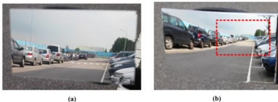
รูปที่ 2 - 12 Reflective images of (a) a flat mirror and (b) a freeform reflector
