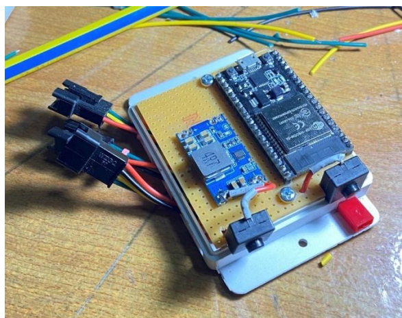
รูปที่ 3 - 35 ติดตั้งบอร์ด ESP32-S พร้อมโมดูล Mini 560 และสวิตช์ควบคุมระบบ
