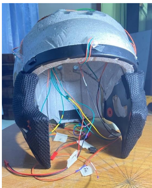
รูปที่ 3 - 37 เดินสายเซนเซอร์จากหมวกเข้าสู่กล่องควบคุม
