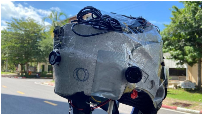
รูปที่ 4-2 แสดงการติดตั้งเซนเซอร์อัลตราโซนิกด้านหลังของหมวกกันน็อก สำหรับตรวจจับวัตถุที่เคลื่อนเข้ามาทางด้านหลังของผู้ขับขี่
