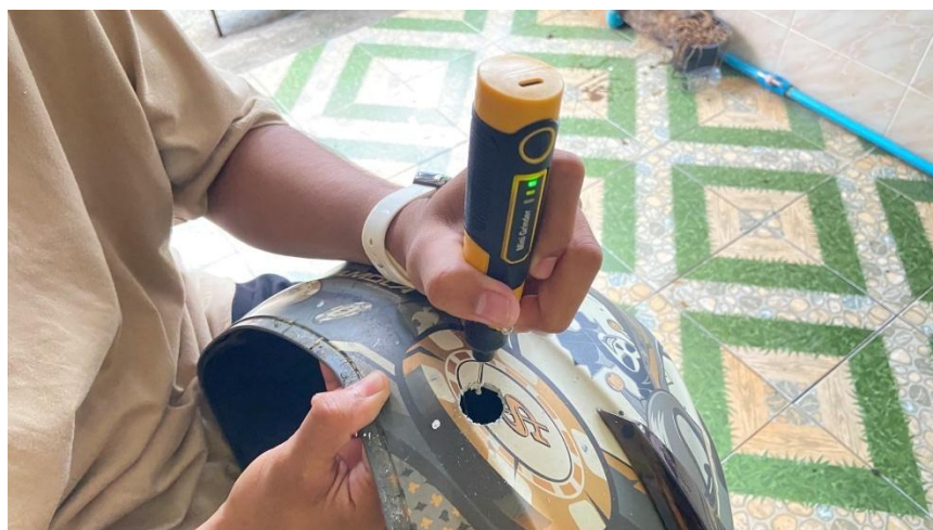
รูปที่ 3 - 29 แสดงขั้นตอนการเจาะหมวกเพื่อเตรียมติดตั้งเซนเซอร์
