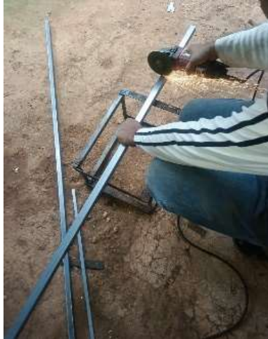
ภาพที่ 3-20 การตัดเหล็กกล่องให้ได้ขนาดความยาวตามที่ออกแบบไว้
