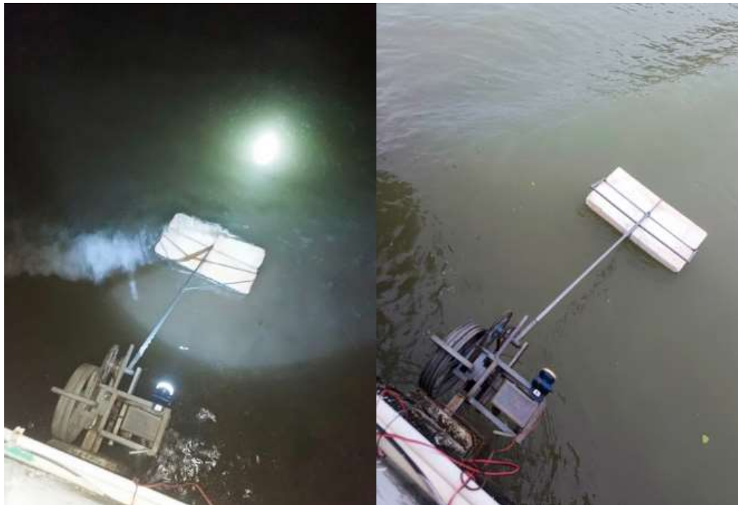
ภาพที่ 4-1 การติดตั้งทุ่นลอยน้ำผลิตไฟฟ้า
