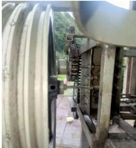
ภาพที่ 3-27 เชื่อมชุดทดรอบเฟืองโลหะกับโครงสร้าง
