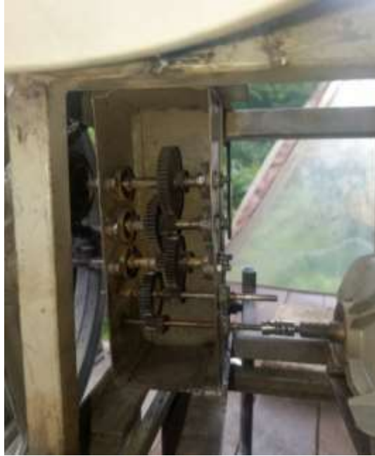
ภาพที่ 3-26 เชื่อมชุดทดรอบเฟืองโลหะกับโครงสร้าง
