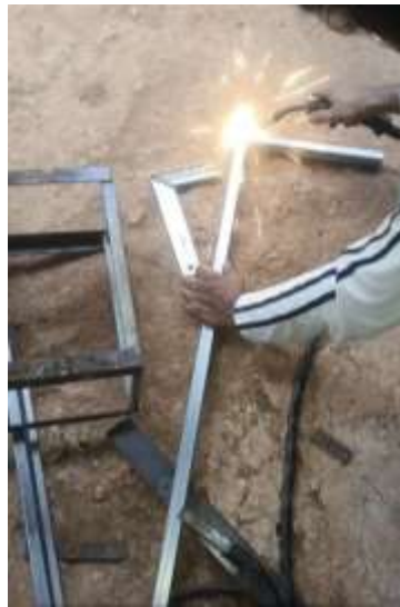
ภาพที่ 3-21 การเชื่อมเหล็กกล่องตามการออกแบบโครงสร้าง
