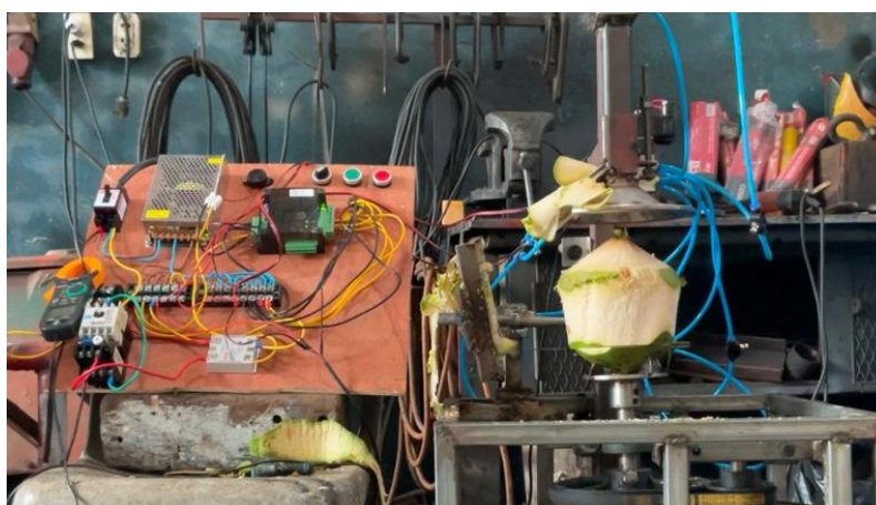
รูปที่ 4.6 การปอกด้านหัวของเครื่องปอกเปลือกมะพร้าวน้ำหอมอัตโนมัติ
