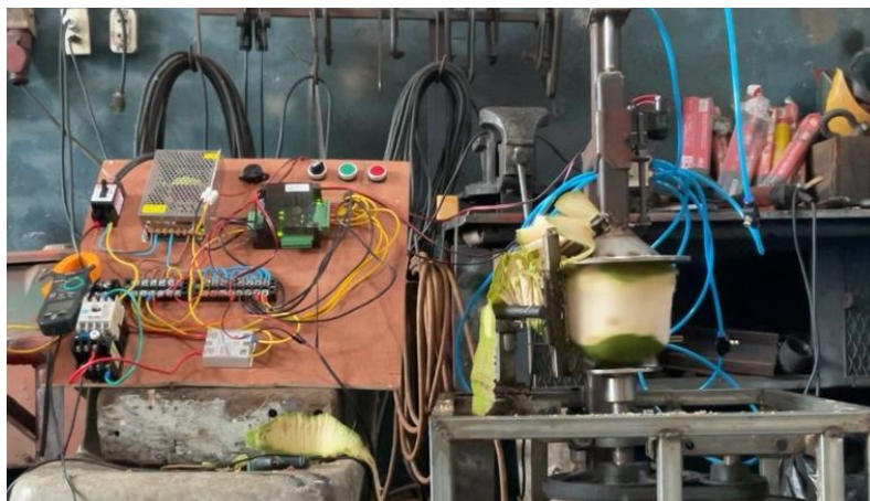
รูปที่ 4.5 การปอกด้านข้างของเครื่องปอกเปลือกมะพร้าวน้ำหอมอัตโนมัติ
