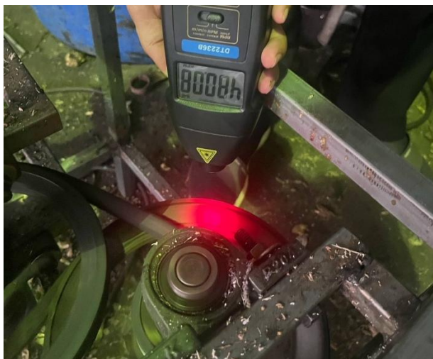
รูปที่ 4.7 ความเร็วรอบมู่เลย์ชุดฝั่งมอเตอร์
