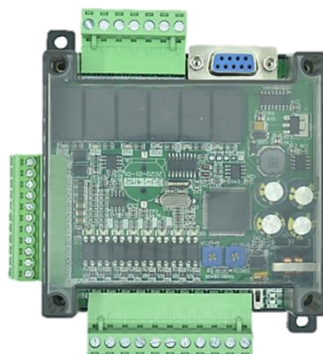
รูปที่ 2.15 บอร์ดควบคุม PLC FX3U-14MR
