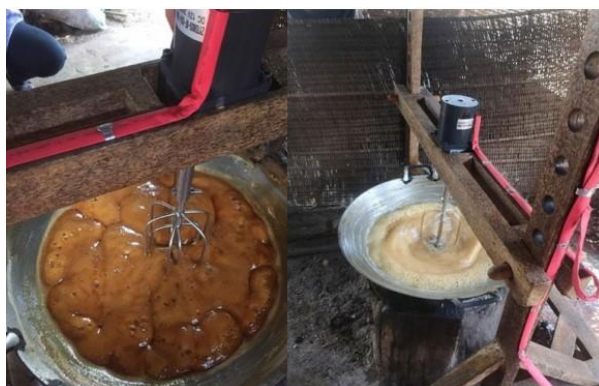
รูปที่ 2.1 การเคี่ยวโดยใช้เครื่องกวนพลังงานแสงอาทิตย์
