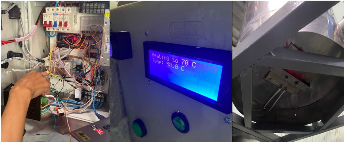
รูปที่ 3.43 ทดสอบ Relay สั่งการทำงานฮีตเตอร์ และแสดงอุณหภูมิผ่านหน้าจอ lcd
