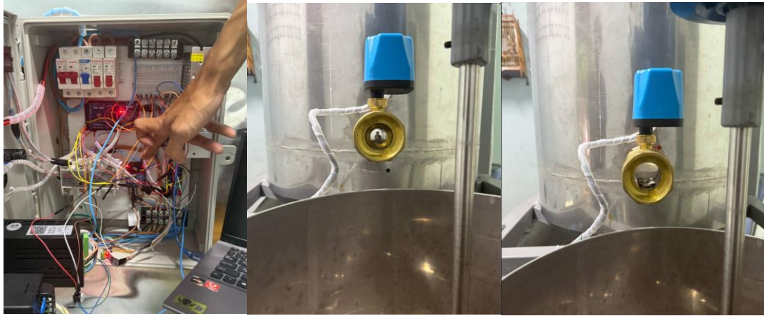
รูปที่ 3.45 ทดสอบ Relay 5V. ควบคุมการเปิดปิดของวาล์ว
