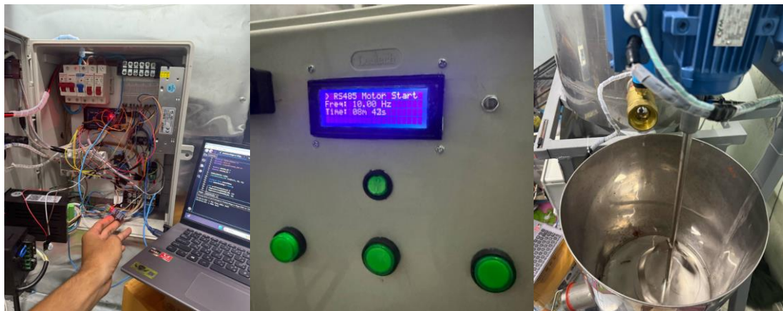
รูปที่ 3.46 ทดสอบมอเตอร์ตัวที่ 2 สั่งการผ่าน RS – 485 สื่อสารผ่าน VFD และแสดงผลการทำงานผ่านหน้าจอ LCD
