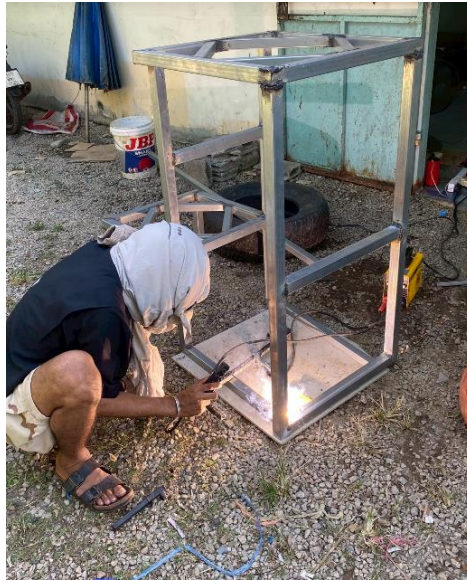
รูปที่ 3.28 ทำการเชื่อมโครงที่วางหม้อใบที่ 1 และ 2 เข้าด้วยกัน
