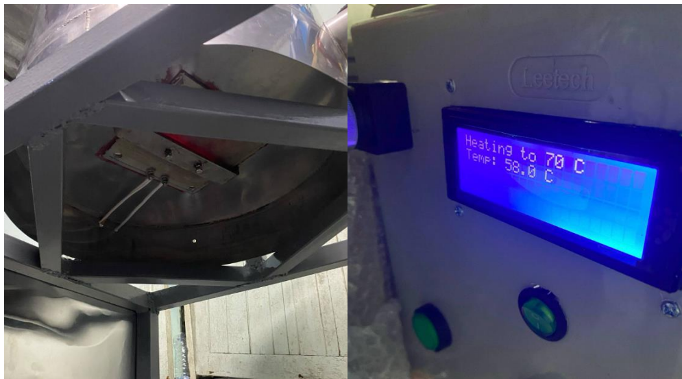
รูปที่ 4.1 ต้มน้ำหม้อแรกที่อุณหภูมิ 70 องศา
