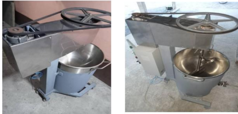
รูปที่ 2.4 โครงสร้างเครื่องกวนกาละแมโบราณกึ่งอัตโนมัติ
