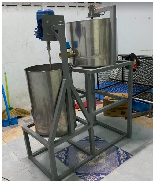
รูปที่ 3.33 ทำการติดตั้งที่ยึดและมอเตอร์ตัวที่ 2
