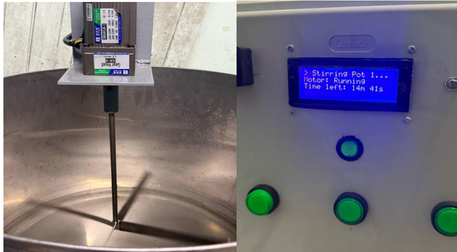
รูปที่ 4.2 มอเตอร์ตัวที่ 1 เริ่มทำงาน และแสดงค่าสถานะการทำงานและเวลาผ่านหน้าจอ LCD
