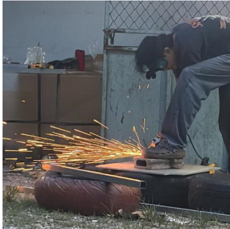
รูปที่ 3.26 วัดและตัดเหล็กให้ได้ขนาดตามแบบที่กำหนด
