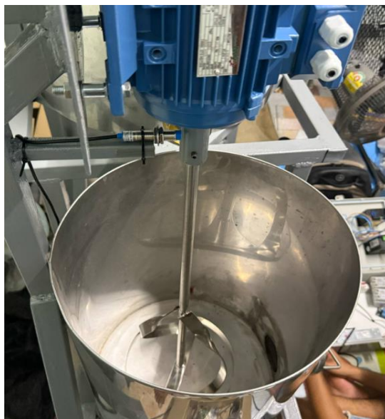
รูปที่ 3.35 ทำการติดตั้งใบพัดกับเฟลมอเตอร์ตัวที่ 2
