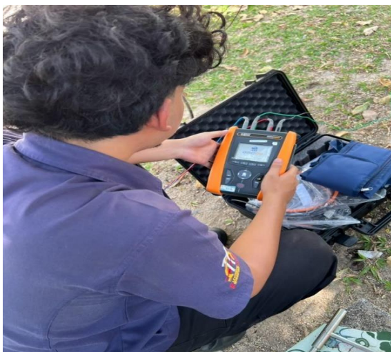
ภาพที่ 3.4 ลงพื้นที่วัดค่าความต้านทานแท่งหลักดินและ ค่าความต้านทานจำเพาะของดิน
