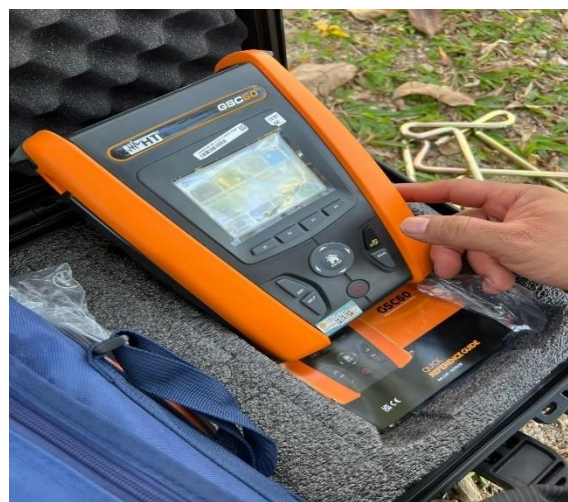
ภาพที่ 3.4 ลงพื้นที่วัดค่าความต้านทานแท่งหลักดินและ ค่าความต้านทานจำเพาะของดิน
