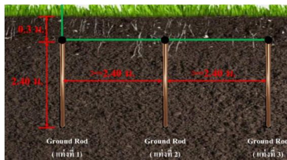
ภาพที่ 2.5 การตอกแบบเป็นแนวตรง 3 หลัก
