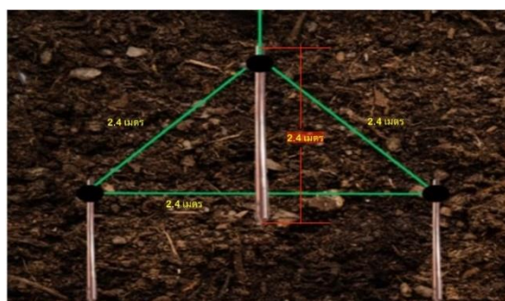
ภาพที่ 2.4 การตอกแบบสามเหลี่ยมเดลต้า
