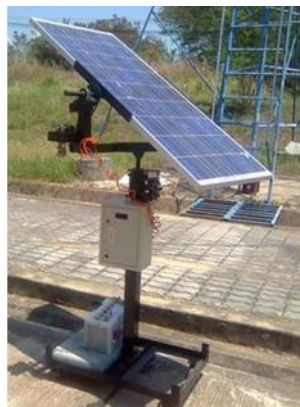
ภาพที่ 5 โครงสร้างระบบเก็บพลังงานไฟฟ้าด้วยโซลาร์เซลล์แบบติดตามความเข้มแสง
