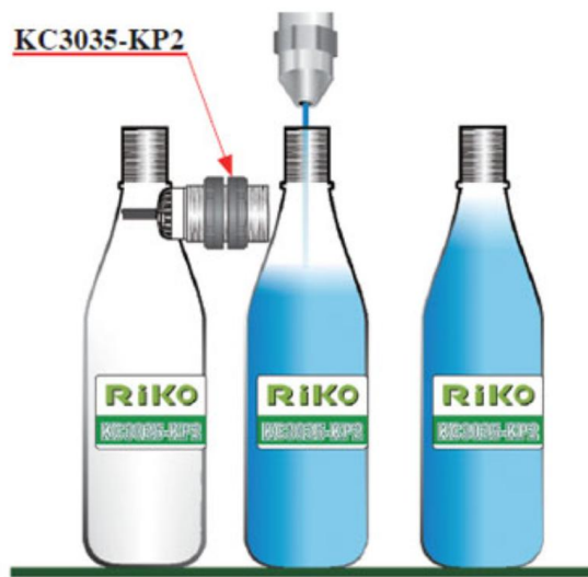
ภาพที่ 7 ตรวจจกระดับการเติมของเหลวลงในขวดแบบไม่สัมผัส (ที่มา : https://www.riko.in.th/11-sensors-basic-knowledge?start=4 )
